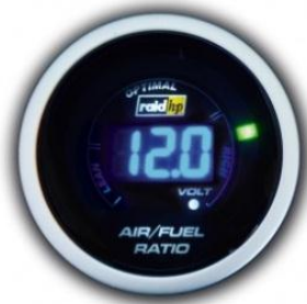
Fig 7.24: Digital luft/drivstoff - forholdsmåler (47).
