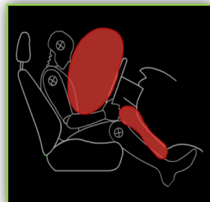
Fig 5.27: Etter at føreren er blitt kastet bakover, kaster hodestøtten ham igjen mot kollisjonsputen (7).
