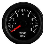
Fig 7.50: Analog turteller som har lyse, hvite sifre på mørk bakgrunn. Målområdet: 0 - 8000 rpm (48).
