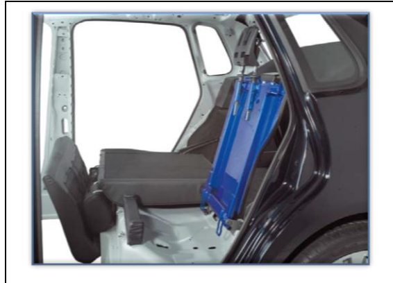
Fig 7.7: CRH-baksetesystemet vist her oppfyller også kravene om å være komfortable og fleksible. I dette baksetesystemet kan seteputen vippes opp og seteryggen felles ned slik at den kommer i 90 ° posisjon og bagasjerommet blir utvidet. Systemet vist her har regulerbar seterygg og variable låsestillinger (30).
