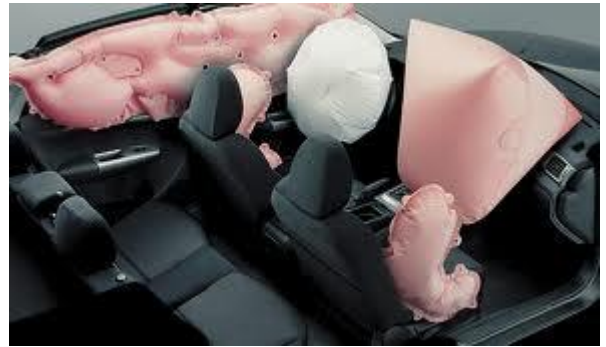
Fig 5.29: Oversikt over front- og sidekollisjonsputer i en bil sett innenfra (17).
