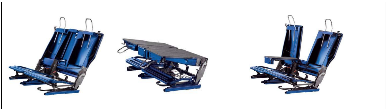
Fig 7.6: CRH baksetesystem som vises her oppfyller kravene om å være komfortable og fleksible. Systemet har lengdejustering med maks. 200 mm, har midtposisjon med belteintegrering, kan regulere ryggstøttens vinkel, er ensidig løsbart og det er aktuelt med enkel innstigning. I tillegg kan man folde seteryggen ned i 90 ° posisjon og seteputen kan senkes, slik at man på denne måten kan optimalisere bagasjerommet. Midtsetet kan foldes ned separat og brukes som bord (30).
