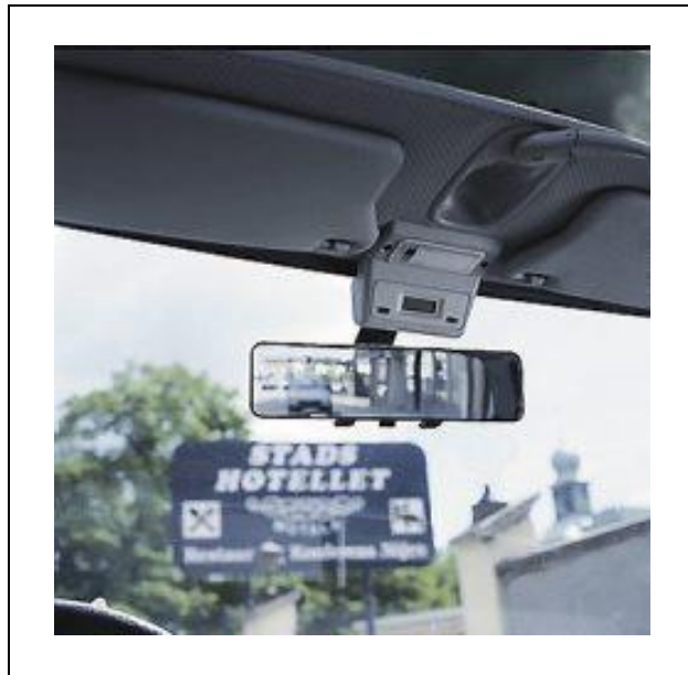
Fig 7.83: Dette panoramaspeilet monteres over det ordinære innvendige speilet, det gir bedre sikt bakover. Med blendfritt, konvekst glass. Målene på panoramaspeilet er 268 x 65 mm. Passer de fleste biler (48).
