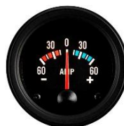
Fig 7.46: Analogt amperemeter som viser strømstyrken (A) med lysende hvite sifre på mørk bakgrunn. Målområdet: -60 A til +60 A. For innbygging Ø 52 mm. Kun 12 V (48).
