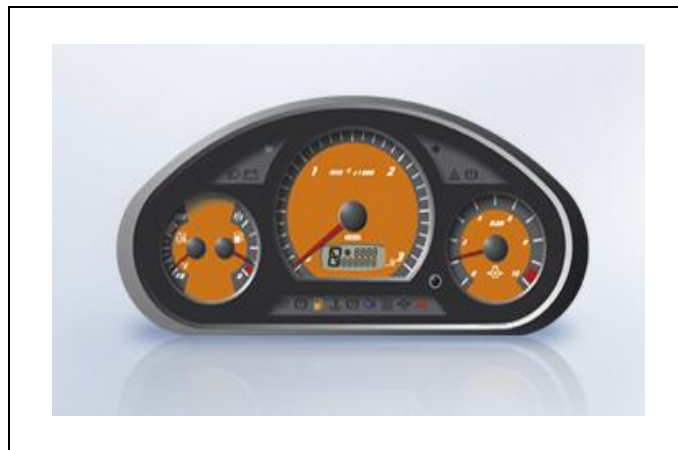
Fig 7.15: Instrumentpanelet Sentrobase 500(CB 500) fra VDO. Dette klusteret (klyngen) kan brukes i forskjellige biler og har både analoge og digitale instrumenter. Dette har analog indikasjon på turtallet, batteriet, hastigheten, temperaturen og drivstoffet. Det har digital indikasjon på timetelleren, kilometertelleren, tripptelleren, timetelleren, klokken og girskiftet. I tillegg har dette indikasjon på 15 varsellamper. Instrumentpanelet CB 500 kan programmeres slik at det tilpasses kundespesifikke behov ved bruk av CentroWin programvare (46).
