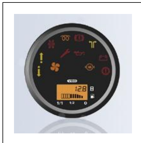
Fig 7.17: Instrumentpanelet Sentrobase 300 (CB 300) fra VDO. Dette instrumentpanelet har analog indikasjon på turtallet, trykket, hastigheten, temperaturen og drivstoffet. Det har digital indikasjon på timetelleren og har en søylediagramindikasjon som kan indikere spenningen, drivstoffet, temperaturen og trykket. I tillegg har det en indikasjon på 8 varsellamper. Instrumentpanelet CB 300 kan programmeres slik at det tilpasses kundespesifikke behov(46).
