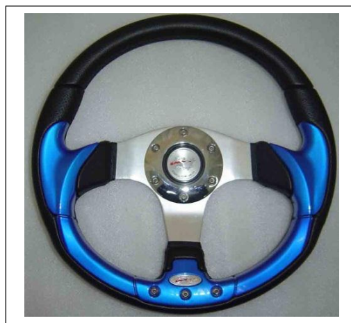
Fig 7.11: Et sportsratt uten kollisjonspute med en diameter på 320 mm (44).
