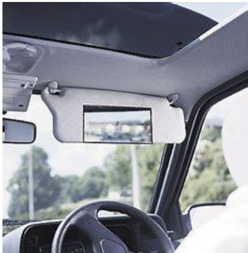
7.81: Make-up-speil med blendfritt glass. Det kan festes på solskjermen med ståklips. Målene på Make-up-speilet er 170 x 92 mm (48).
