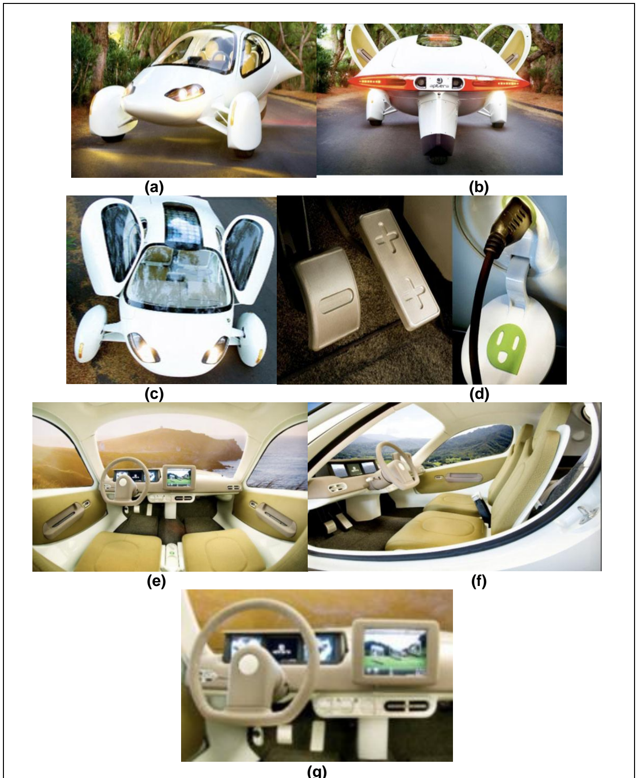
Fig 4.3: Apera kjøretøyet (8), a), b) og c) Eksteriøret til kjøretøyet sett forfra, bakfra og ovenfra, d) Brems, gasspedalen og kontakten av kjøretøyet til elektriske kilden, e) og f) Interiøret av kjøretøyet, g) Detaljer som inkluderer alle standarder funksjoner, inkludert kollisjonspute i rattet, digital instrumentmåler, et ryggekamera, GPS navigasjon, og en CD/MP3/DVD Spiller.
