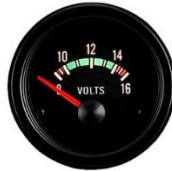
Fig 7.48: Analogt voltmeter som viser spenningen (V) med lysende hvite sifre på mørk bakgrunn. Målområdet: 0-16 V. For innbygging Ø 52 mm. Kun 12 V (48).
