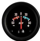
Fig 7.87: Analog amperemeter som viser strømstyrken (A) med lysende hvite sifre på mørk bakgrunn. Målområdet: -60 A +60 A. For innbygging Ø 52 mm. Kun 12 V.
