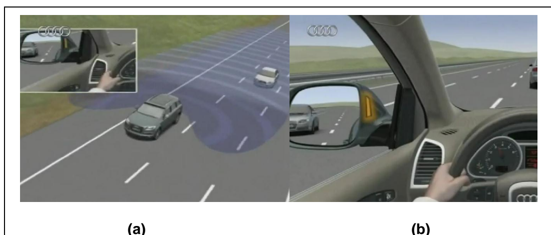
Fig 5.32: Oversikt over virkemåte av varsellampe i sidespeilet (19,29). a) Det området som varsellampe advarer mot, b) varsellampe blinker når en potensiell fare er der og advarer føreren mot å skifte kjørefeltet.
