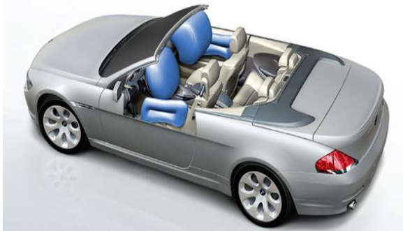
Fig 5.28: Oversikt over front- og sidekollisjonsputer i en åpen bil (15).
