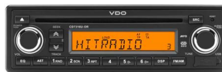
Fig 7.60: En multimediaspiller fra VDO som har mange funksjoner. Den har cd-spiller, radio, Bluetooth og mulighet for tilkobling til mobiltelefon (46).
