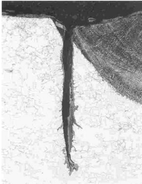
Figur 1-1 Forsidebilde. Forstørret bilde av utmattingssprekk i sveisetå [17]
