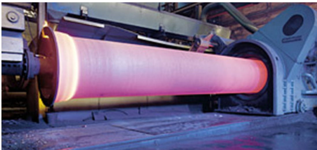
FIGUR 3.5 – ET STØPEJERNSRØR TAR FORM (DUKTUS.COM 2012)
