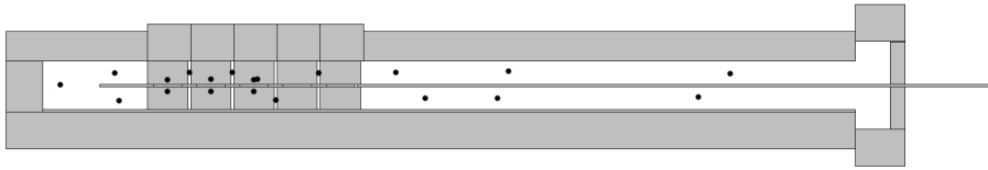
(a) Første termistoroppsett. Her måles lufttemperaturen mellom kjøleribbene. To av TEC-modulene har ikke termistorer i kjøleribbene.
