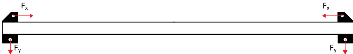
Figur 3.4. Skissen viser hvordan kreftene fungerer på bjelken når jeg ser på konstruksjonen fra et 2D perspektiv. Dette blir en forenklet modell, men likevel ganske realistisk.
