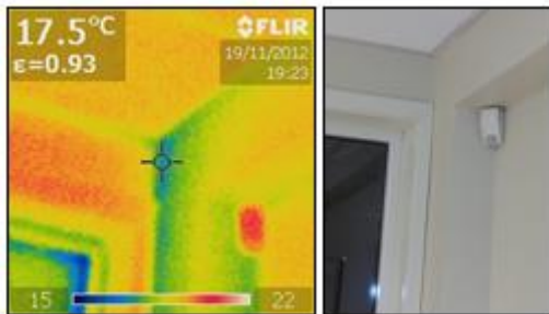
Figur 39: Termografi av søyle møter drager i eksisterende bygning
