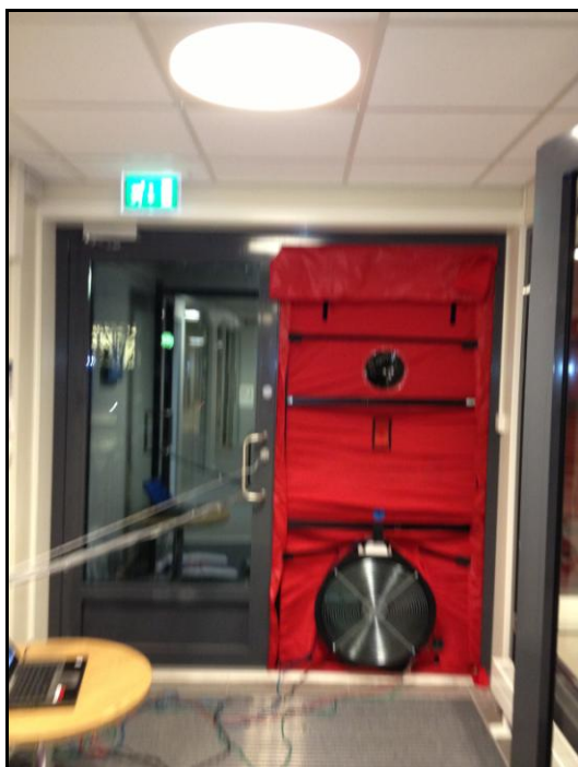
Figur 9: Minneapolis Blower Door i hovedinngang for kontorlokalet
