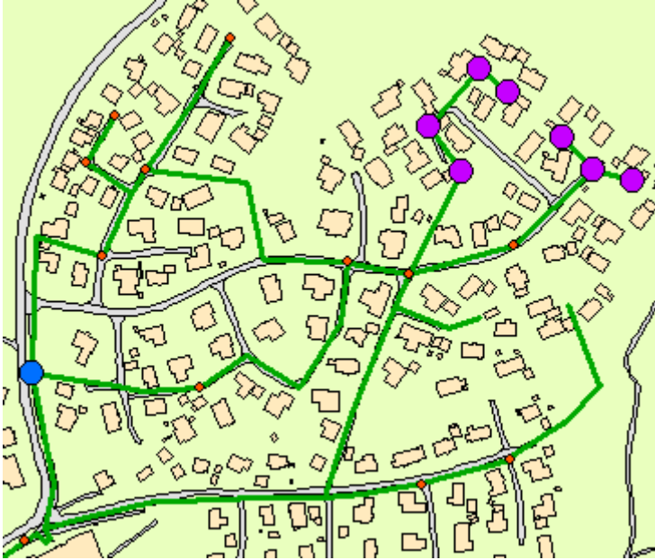
Figur 8.9 viser uttak av brannvann fra kum 13777. Kartet er fra nr. U4, og kummene er i pumpesonen til Slevik.
