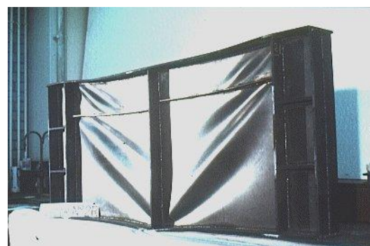
Figur 1.3 - Strekkfelt mellom stivere
