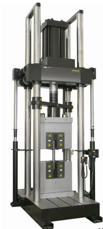
Figur A.9 - Eksempel på hydraulisk presse, her konfigurert for strekk
