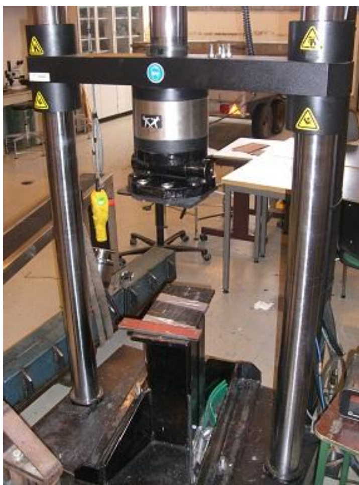
Figur A.10 - Satec Instron 300 kN ved IMT, UMB
