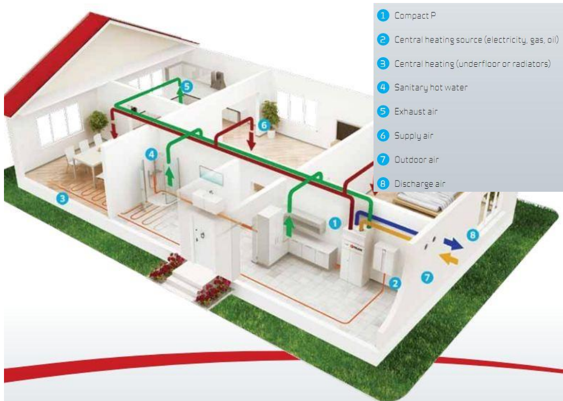
Bilde 1: Prinsipp for innføring av Nilan Passivhusaggregat. Illustrasjon: www.nilan.dk
