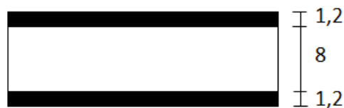
Figur 5-10: Divinycell omgitt av karbonfiber. Mål i mm
