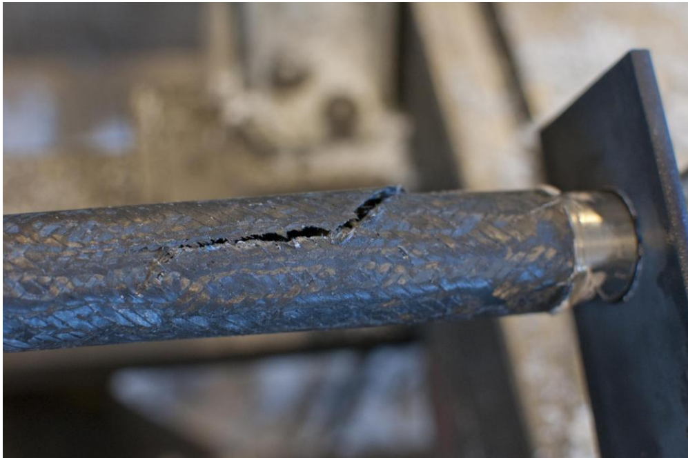
Figur 5-22: Brudd i aksling på lav belastning. Bruddet oppsto i rørets lengderetning, og skyldes trolig feil i støpeprosess/bearbeiding (Figur 5-22) [23]
