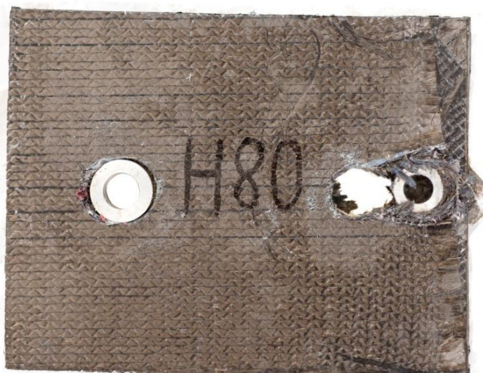
Figur 5-16: Sandwich m/H80 etter test [23]
