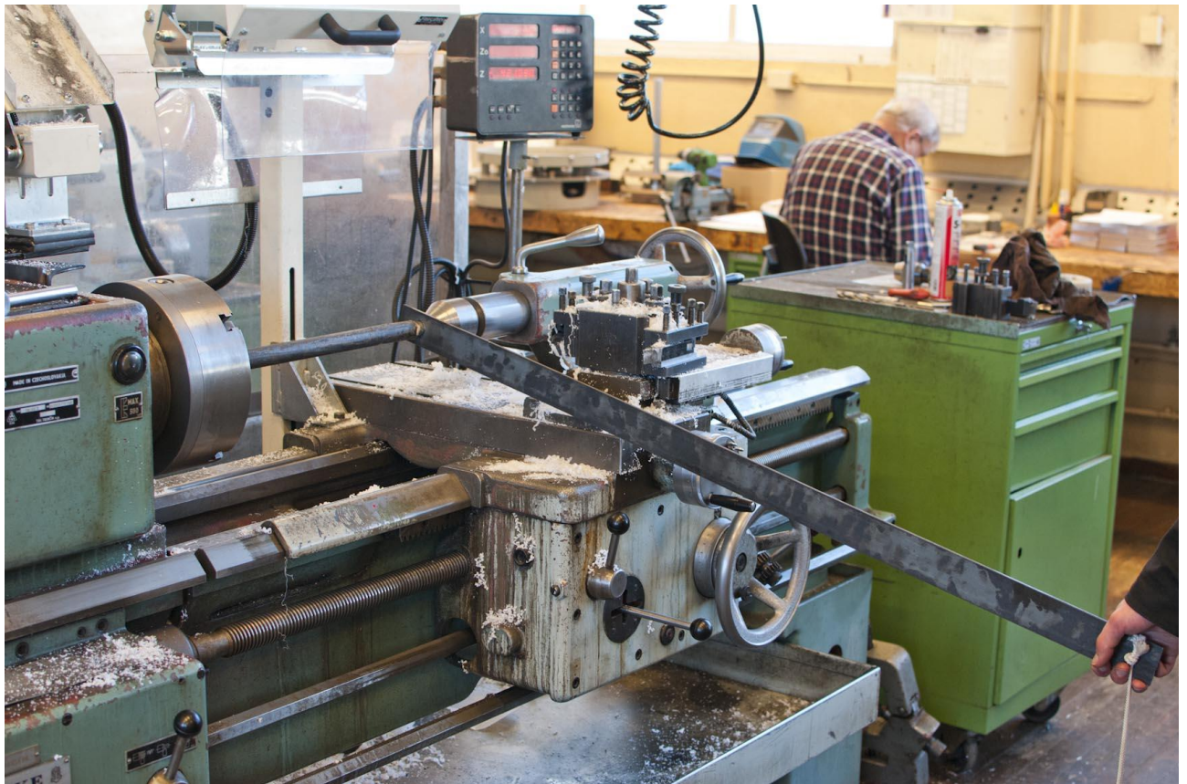
Figur 5-21: Aksling innspent i dreiebenk med påsveiset arm. Armen blir belastet med en vertikal kraft hvilket medfører at akslingen blir belastet med et moment. Kraften økes sakte til torsjonsbrudd oppstår. Vha. en lastcelle festet til tauet t.h. i bildet avleses den påførte kraften, og bruddmomentet måles [23]
