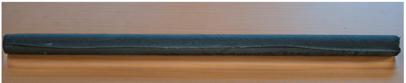
Figur 5-19: Karbonaksling før bearbeiding. Fra støping blir karbonfiber strukket enkelte steder grunnet vakuomet (se Figur 5-20). Disse kantene dreies ned og hylser limes inn [23]
