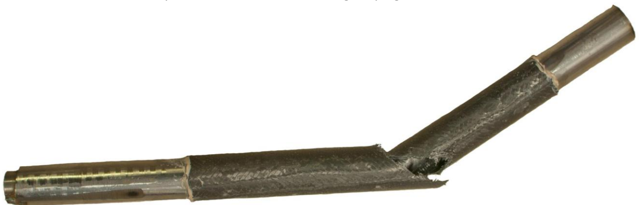
Figur 5-23: Brudd i aksling. Her oppsto bruddet 45° på fiberretningen, og er dermed et torsjonsbrudd [23]
