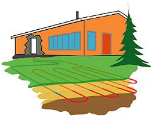
Figur 9: Jordvarme med kollektorslanger (Natur-Energi 2010)
