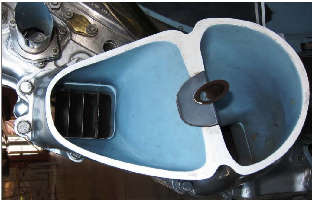
Figur 19: Tverrsnitt av en diffusor i en radialkompressor, fotografert på Teknisk Museum.
