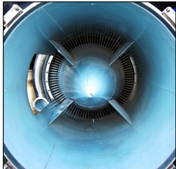
Figur 34: Eksosutløp på en "DH Goblin" gasturbinmotor sett bakfra, fotografert på Teknisk Museum. Turbinen er i starten av eksosutløpet.
