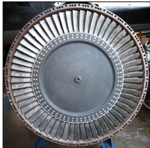
Figur 32: Turbinrotor sett fra gassurbinens bakre del, fotografert på Teknisk Museum. Eksosutløpet er demontert, og er ikke med på bildet.
