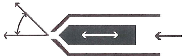
Figur 24: Skisse av en duplex regulerbar drivstoffventil. En kon regulerer spredevinkelen ut fra ventilen.
