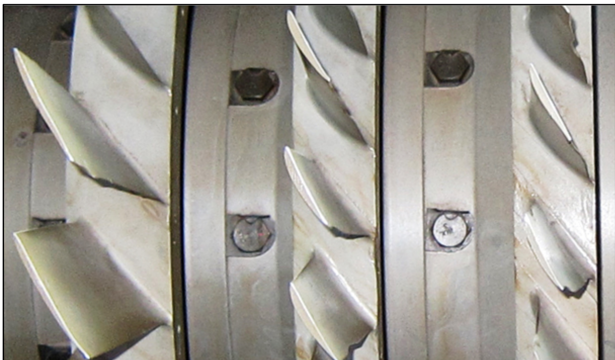
Figur 22: Nærbilde av rotorblader fra kompressoren til "Junkers Jumo 004B" gassturbinmotor, fotografert på Teknisk Museum. Bladene står forholdsvis tett slik at det dannes diffusorpassasjer mellom dem (13).
