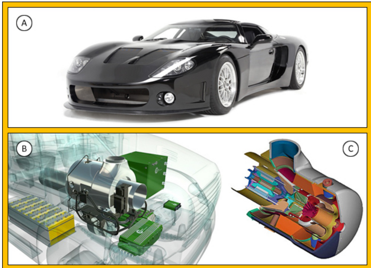
Figur 9: A) Capstone CMT-380 konseptbil (24), B) Illustrasjon av en Capstone gassturbin plassert i en vilkårlig bil (25), C) Capstone C30 gassturbin (24).
