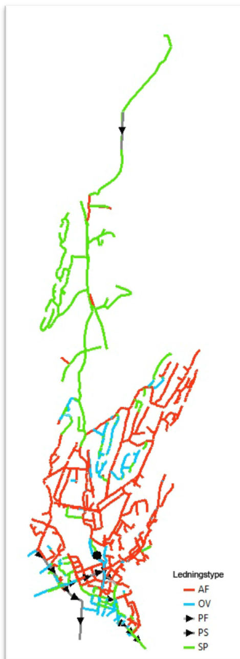
Figur 25: Oversikt over ledningstyper i Fredrikstad. AF = Fellesavløpsledninger, OV = overvannsledninger, PF = pumpeledning fellesavløp, PS = pumpeledning spillvann, SP = spillvannsledning
