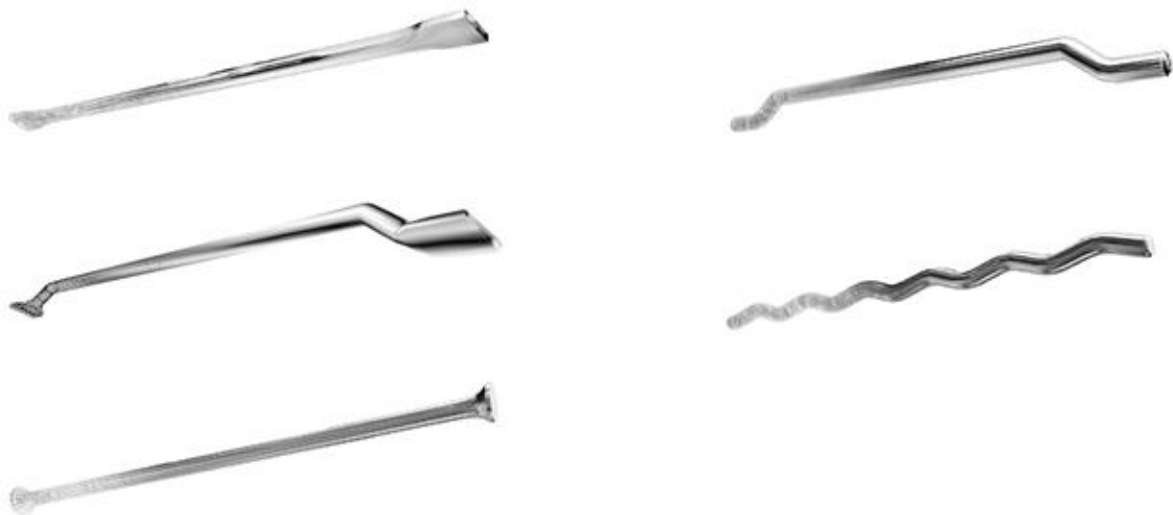
Figur 2.8: Forskjellige typer stålfiber (16)
