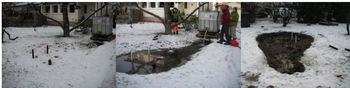
Figur B-4. Vintersimulering 17.12.11. Til venstre: Før vanntilførsel. I midten: Vanntilførsel med hjelp fra Jo Egil Klever (ISS Landscaping). Til høyre: Tilstand i regnbedet etter endt simulering. Foto: Bent C. Braskerud
