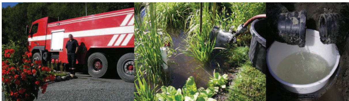
Figur B-3. Syntetisk nedbørsimulering ved H8. Til Venstre: Arild Karlsen, Redningsetaten i Gauldal. I midten: Vanntilførsel i regnbed under syntetisk nedbørsimulering med . Til høyre: Frakobling i bend for vannføringsmåling i overløpsledning. Foto: Bent C. Braskerud
