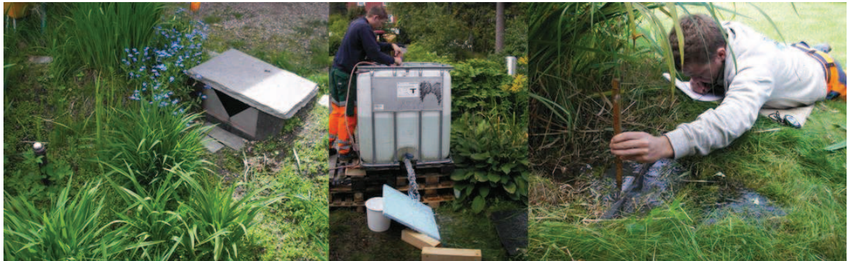
Figur B-1. Bilder av feltarbeid i L34B. Til venstre: Innløpskasse med 90 grader V-profil for vannføringsmåling. I midten: Vanntilførsel under simulering med syntetisk nedbør, med hjelp fra Jo Egil Klever (ISS Landscaping). Til høyre: Vannføringsmåling i V-overløp. Foto: Bent C. Braskerud
