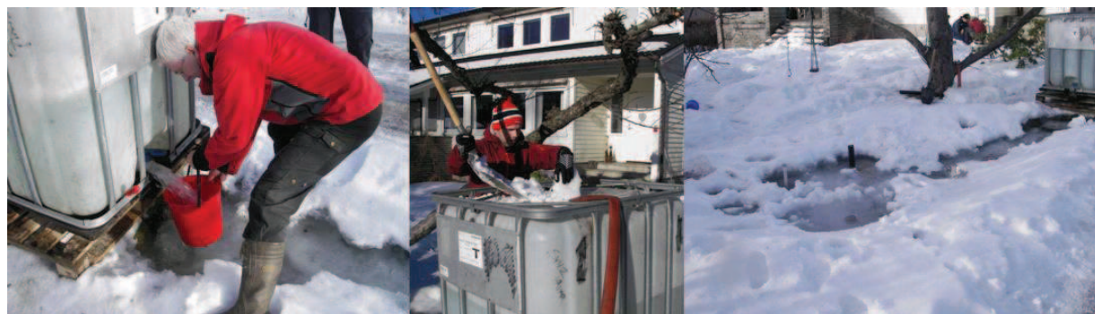
Figur B-5. Vintersimulering 21.02.12. Til venstre: Vannføringsmåling med bølge - tid metoden. I midten: Tilførsel av snø for å oppnå riktig vanntemperatur for omstendighetene. Til høyre: Tilstand i regnbed etter simulering. Foto: Bent C. Braskerud
