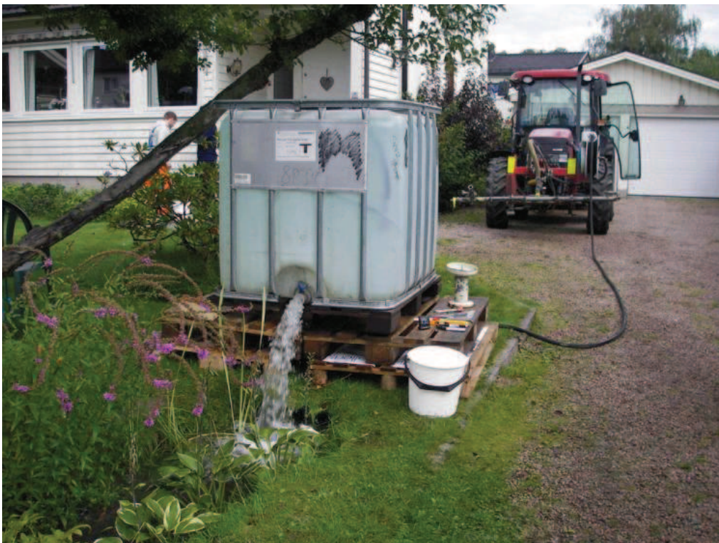
Figur 33. Vanntilførsel i regnbedet ved NB21, under simulering med syntetisk nedbør 01.09.11. Foto: Bent C. Braskerud.
