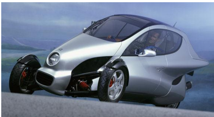
Figur 5.1.7: Viser Mercedes F300 Life Jet basert på tadpoleprinsippet [16.2.18].
