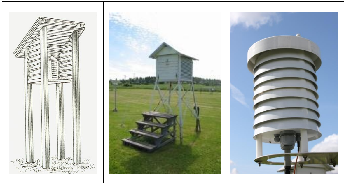
Figur 3.5: Venstre: En «Wildsk» hytte til plassering av instrumenter. Hentet fra [17]. Midten: Dagens meteorologiske hytte (MI-46). Hentet fra [5]. Høyre: Ny type skjerm (MI-74) for PT100-termometer.
