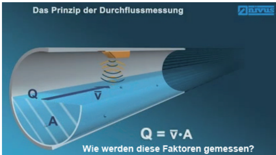
Figur 17: Viser en prinsippsskisse for NIVUS måler.(Nivus 2012)
