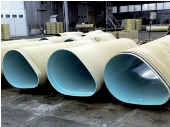
Figur 20: Viser et eksempel på eggformede rør i GRP.(Amiantit 2011)
