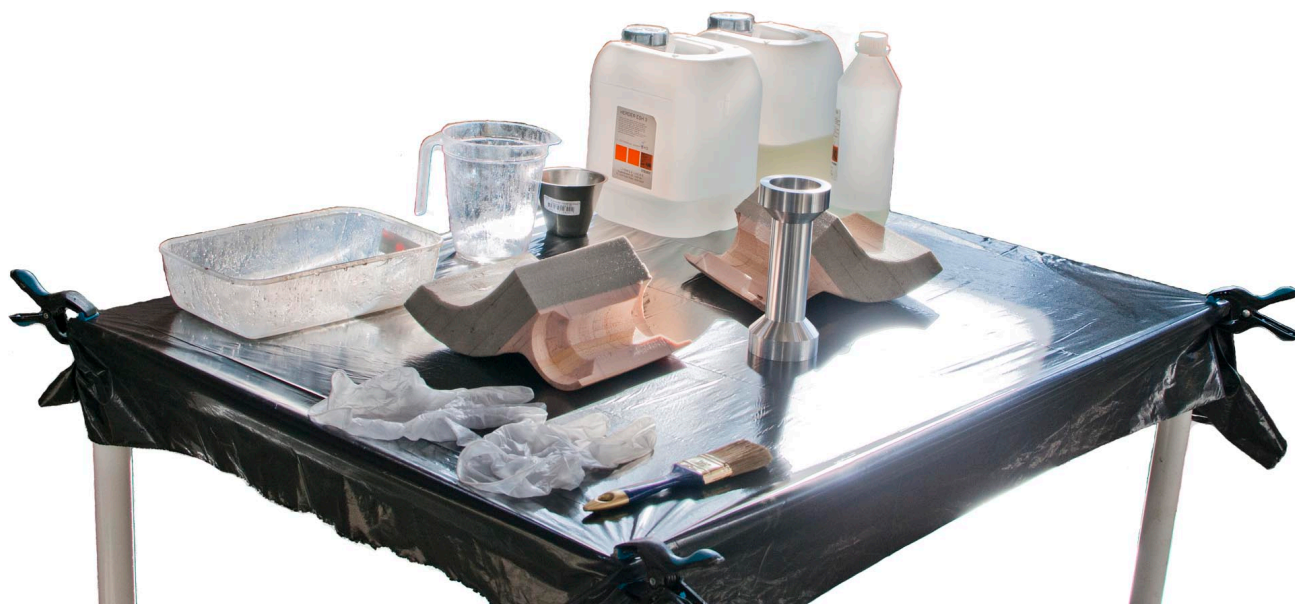
Figur 9-6: Utstyr for støpning med epoksy. (Foto: O. A. Skjong)
