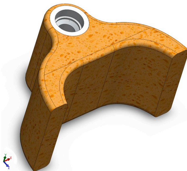
Figur 8-2: Styrehodet i Divinycell H80 med hylse i aluminium 6082 T6 for styrelagerene.
