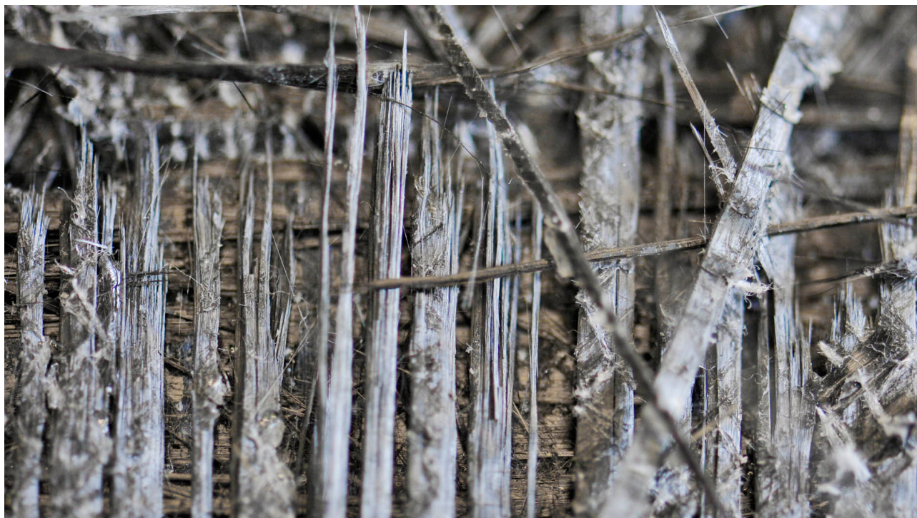
Figur 9-30: Nærbilde av lag 3 i bruddsonen. Man ser her at fibrene har røket langs en relativt jevn linje. Dette tyder på spenningskonsentrasjoner i området. (Foto: O. A. Skjong)
