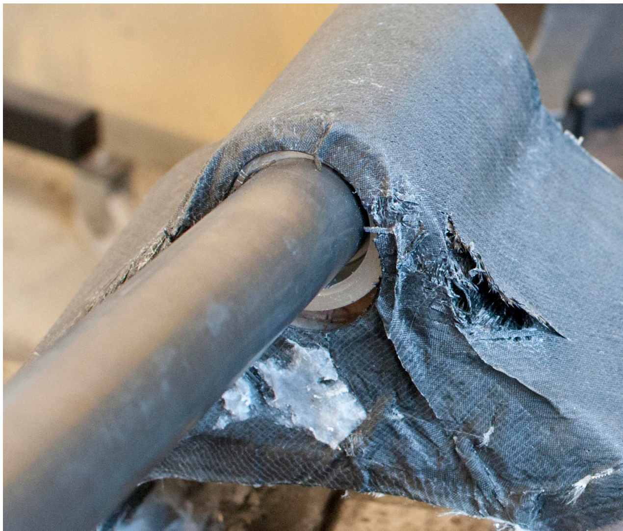
Figur 9-25: Bruddet på høyre side. Her ser vi at det er hovedsakelig lag 1 som har blitt delaminert fra lag 2 og innover, i motsetning til venstre side hvor det var lag 2 som ble delaminert. (Foto: O. A. Skjong)
