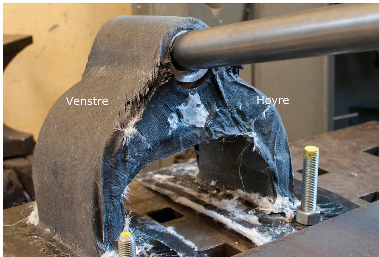
Figur 9-23: Bruddet har inntraffet. Karbonfiberen har blitt delaminert, men det er mye materiale som gjenstår. På denne figuren er høyre og venstre side definert slik som føreren av motorsykkelen vil se det. Denne definisjonen brukes i resten av kapitlet. (Foto: O. A. Skjong)
