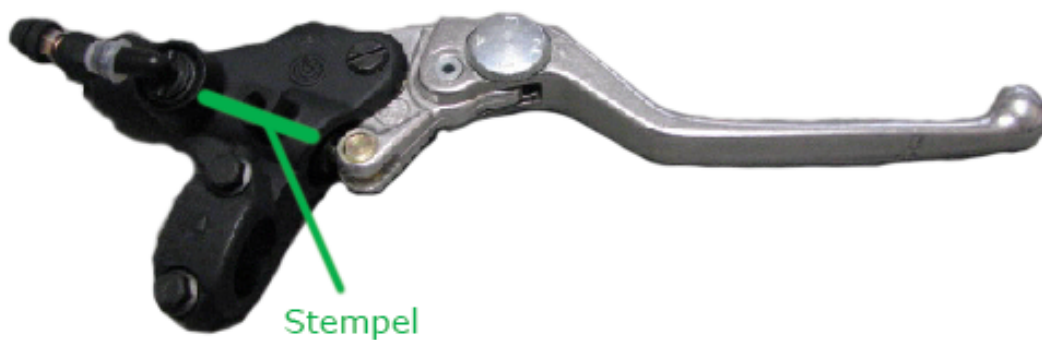
Figur 11-5 [26] : Konvensjonell masterpumpe. Legg merke til hvordan stempelet ligger nesten parallelt med bremsehendelen.
