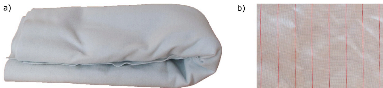
Figur 9-13: a) Filt til å suge opp overskytende epoksy. b) Peel-ply. En sterk og tynn tekstil som brukes innerst mot karbonfiberen i støypeprosessen. (Foto: O. A. Skjong)
