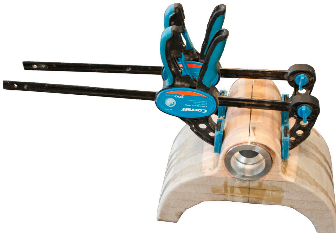
Figur 9-7: Herding av prøvebiten. (Foto: O. A. Skjong)
