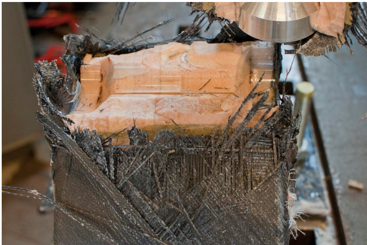
Figur 9-28: Den bakerste delen av styrehodet sto igjen. Legg merke til at fiberen i lag 1 og 2 har blitt revet mye lenger nede på siden enn fibreene i lag 3 og innover. Dette er fordi fibreene i lag 1 og 2 ble rettet ut før de røk. Man kunne også se fiberfragmenter som sprutet flere meter til sidene. Fibrene i lag 3 og innover har blitt holdt på plass av lag 1 og 2, og de har dermed ikke fått rettet seg ut. Derfor er bruddet ganske rett fra lag nr. 3 og innover. (Foto: O. A. Skjong)
