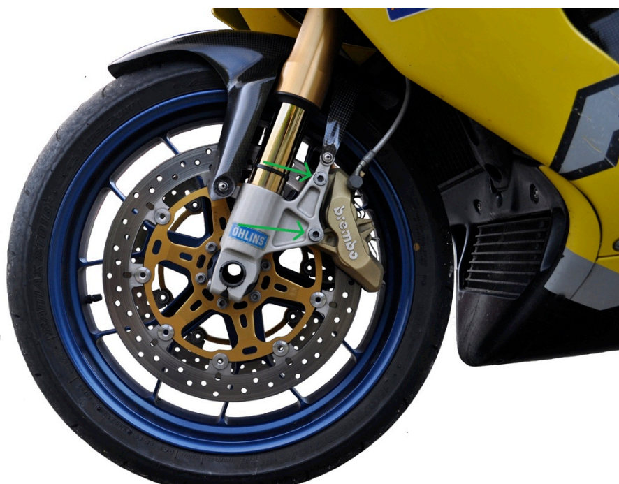
Figur 11-6: 2001 Aprilia RSV Mille R med konvensjonelle bremsekalipere. Legg merke til festeboltene som er parallele med hjulakslingen. (Foto: O. A. Skjong)
