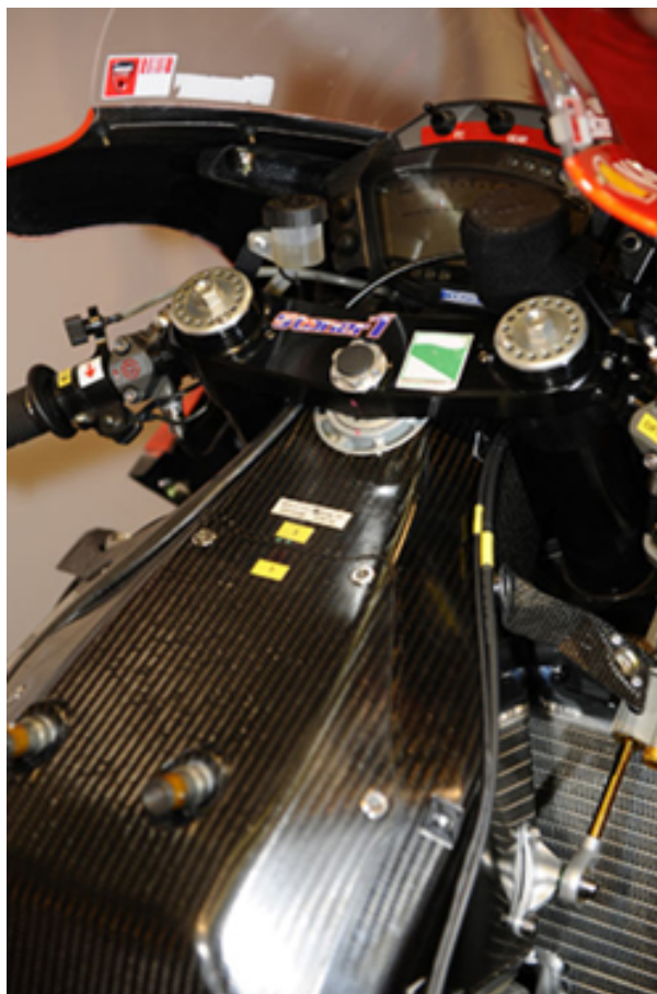
Figur 1-5 [37] : Luftfilterboks i karbonfiber som også gjør nytte som bærende element på Ducati GP9 2009. Siden dette er en konkurransesykkel beregnet på prototyperacing er det mye hemmelighetskremmeri, og det er derfor dessverre vanskelig å oppdrive gode bilder.
