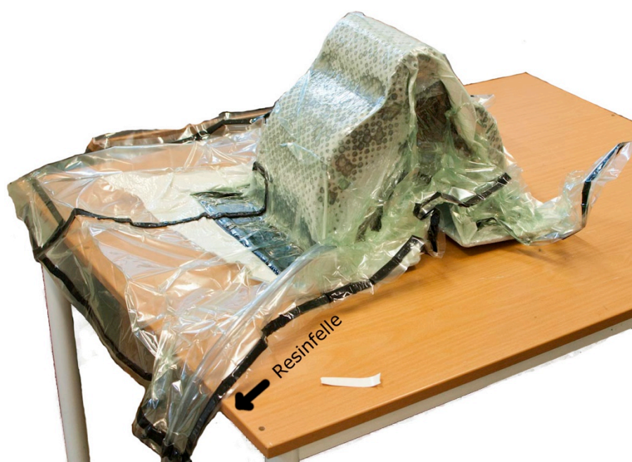
Figur 9-14: Prøvebiten pakket inn i vakuumbag. Slangen som går ut av vakuumbagen i forkant går til vakuumpumpen, via resinfellen. Man kan også se mønsteret på filten. Dette er epoksy som har trukket gjennom hullene i breather-duken. (Foto: O. A. Skjong)
