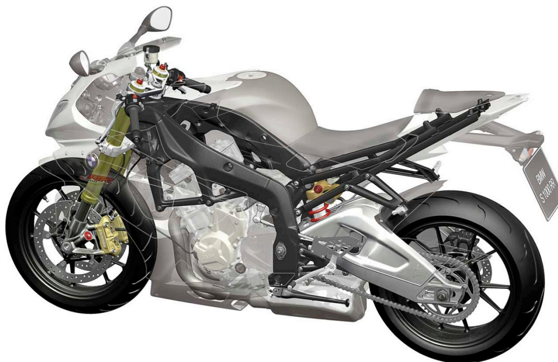
Figur 1-9: BMW S1000RR 2010 [32] . Legg merke til at tverrsnittprofilen varierer, dette er for å få ideelt motstandsmoment over alt.
