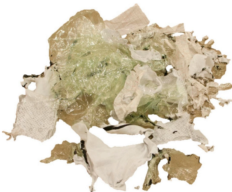
Figur 9-17: Avfall etter støpningen. Denne haugen målte ca. 1,5 m i diameter og var ca. 0,5 m høy. (Foto: O. A. Skjong)
