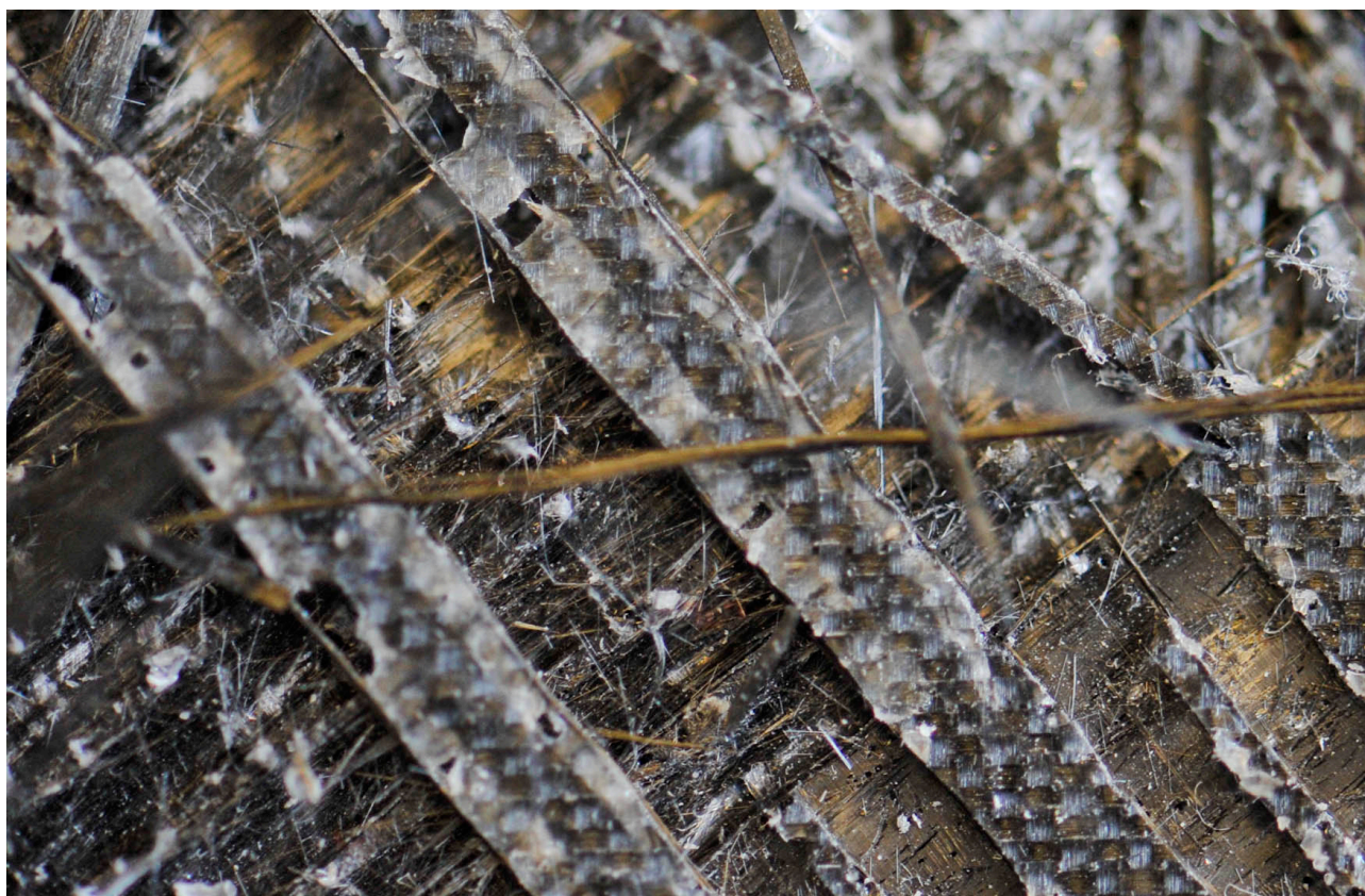
Figur 9-31: Nærbilde av fibrene i bruddsonen. Legg merke til at det kun er deler av lag 1 igjen her. Fibrene i dette laget røk på forskjellige steder, noe som tyder på jevn belastning. Mønsteret på fibrene i lag 1 er avtrykk fra vevingen i peel-plyen. (Foto: O. A. Skjong)
