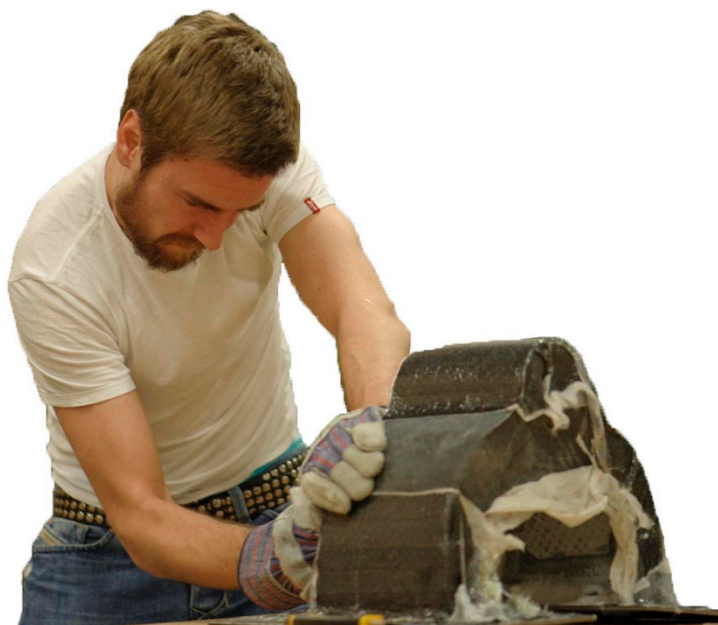
Figur 9-16 [20] : Undertegnede i full gang med å rive av peel-ply. Det tok ca. 3 timer å få av alt sammen.
