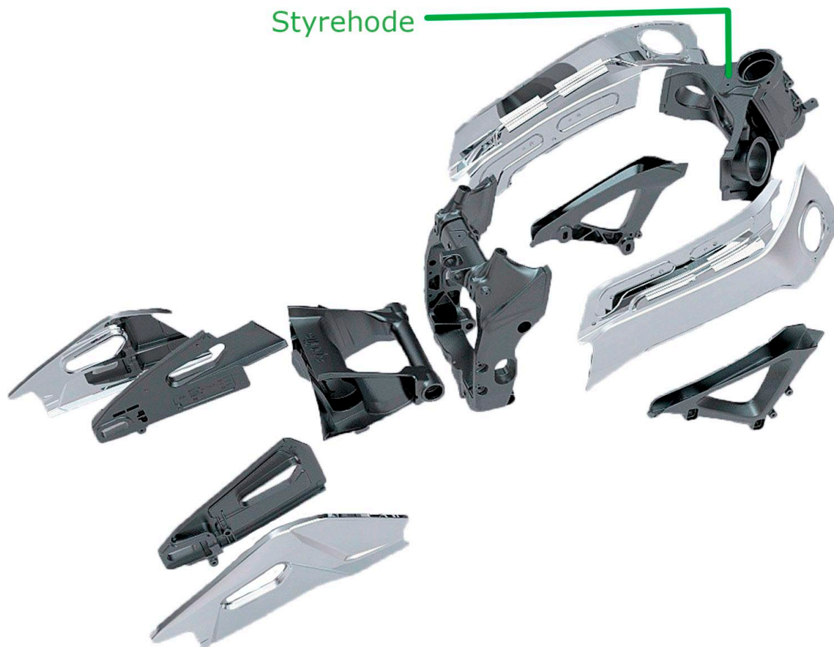
Figur 7-2 [28] : Ekspodert fremstilling av ramme og svingarm til Aprilia RSV4 1000. De mørke komponentene er støpt, og de lyse er stanset. Hullene gjennom vangene helt fremme ved styrehodet er ikke relevante for oss da de er laget slik for at kanalene inn til luftfilterboksen skal være rettest mulig. I høy fart vil disse luftinntakene gi et overtrykk i luftfilterboksen og dermed øke motoreffekten, såkalt "høyfartsturbo" eller "ram air" på engelsk.
