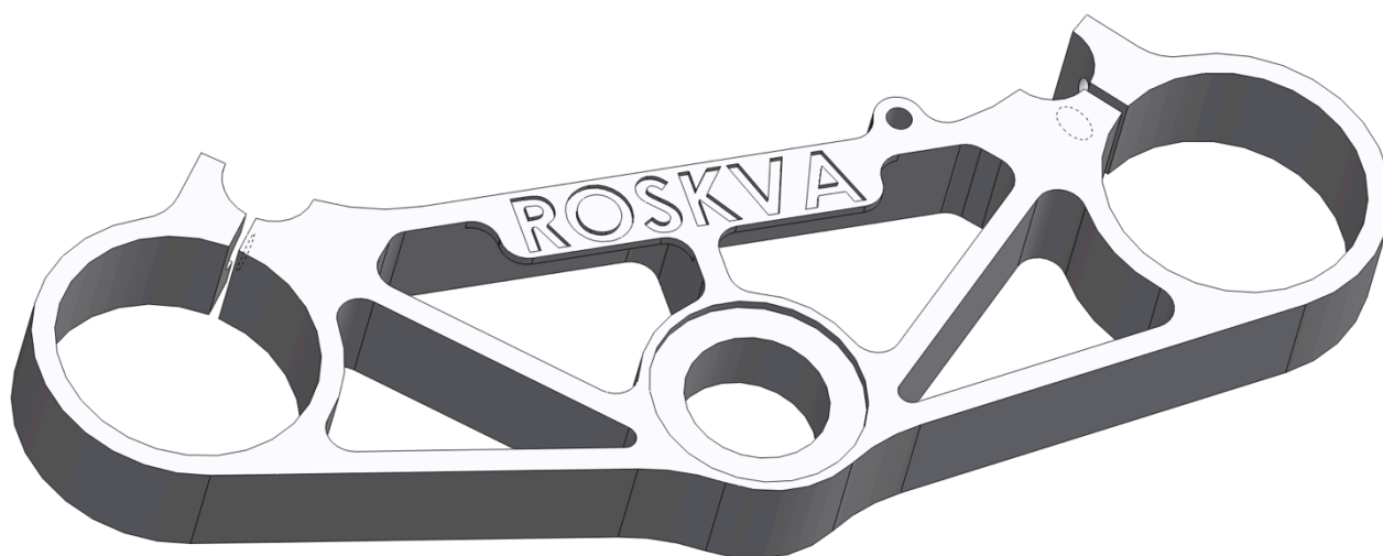
Figur 10-6: Øvre styrebro optimalisert ved hjelp av FEM-analyse.
