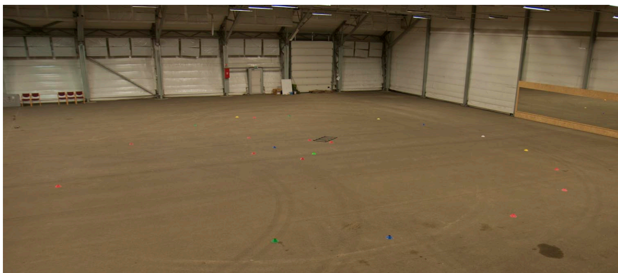
Figur 4-7 [23] : Oppsett av testbanen. Den ytterste delen av banen er halvparten av åttetallet. Midt i bildet ser man vaskebrettet og helt til venstre kan man så vidt skimte 2"x4"-en som ble brukt for å simulere en fortauskant. Testen av akselerasjon og retardasjon ble startet fra hjørnet i bildet. Den røde kjeglen lengst til venstre i bildet er bremsepunktet for retardasjonstesten.
