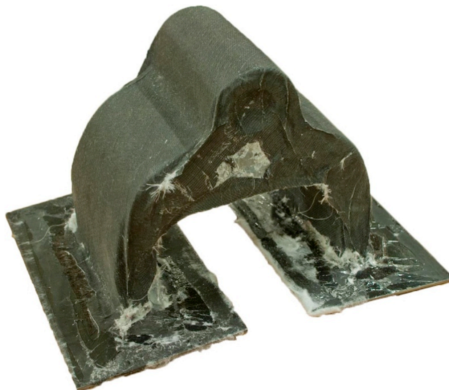
Figur 9-18: Resultatet av støpningen. Legg merke til den hvite flekken midt på. Dette er filt som er umulig å fjerne på grunn av at det ikke var peel-ply under. (Foto: O. A. Skjong)
