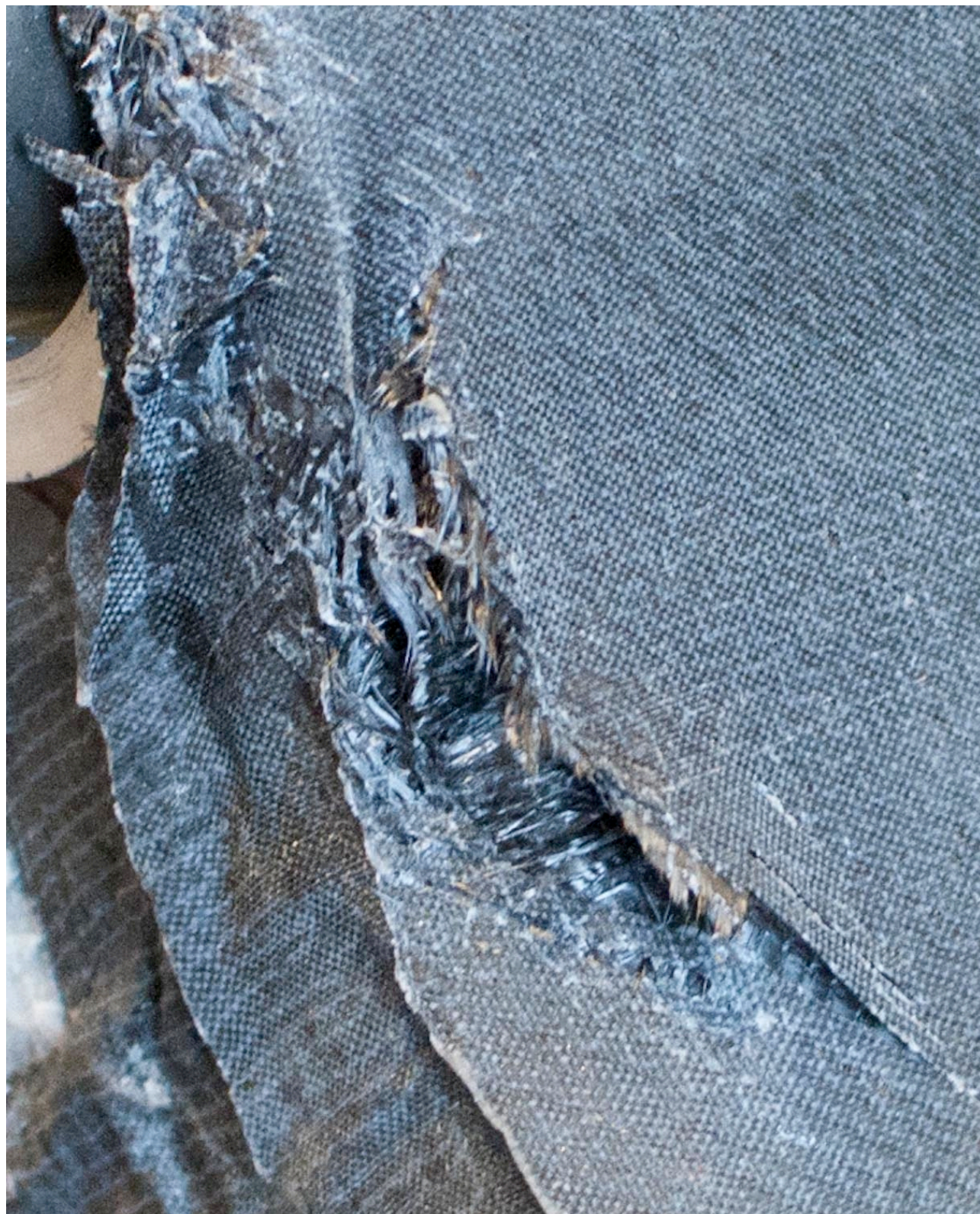
Figur 9-26: Nærbilde av bruddet på høyre side. Her ser man at det er lag 1 som har gitt etter. Dette stemmer svært bra da lag 1 her ligger tilnærmet vinkelrett på kraftretningen. Siden det er den samme duken som ligger rundt forsiden av styrehodet, vil dette da naturlig nok være omvendt av Figur 9-24. Lag 2 og innover ser tilnærmet intakte ut. (Foto: O. A. Skjong)
