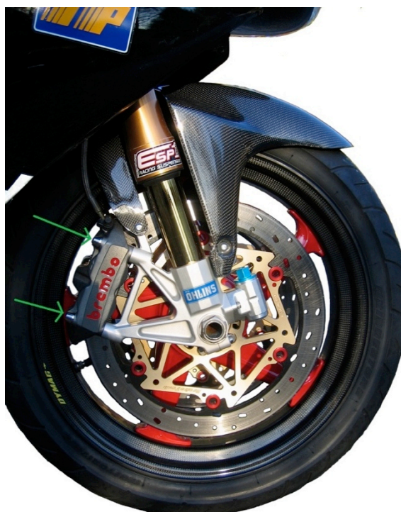
Figur 11-7: Ombygd Aprilia RS 250 med radielt monterte bremsekalipere. Legg merke til festeboltene som står radielt på hjulakslingen. (Foto: O. A. Skjong)
