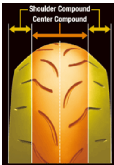
Figur 11-10: Gummiblanding på Bridgestone Battlax BT016 PRO motorsykkeldekk [34] .
