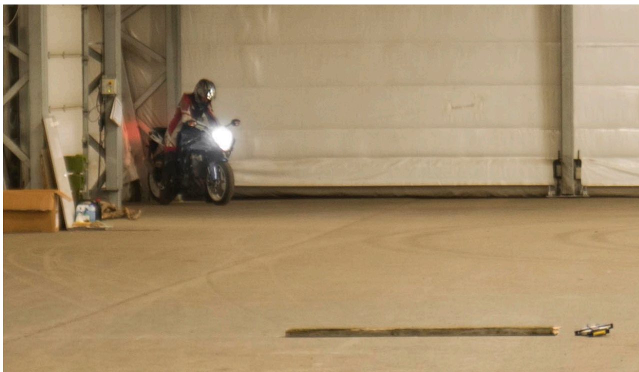
Figur 4-6 [23] : Undertegnede gjør seg klar til test av maksimal akselerasjon og retardasjon. I forgrunnen kan man se 2"x4"-en som ble brukt til å simulere en fortauskant.
