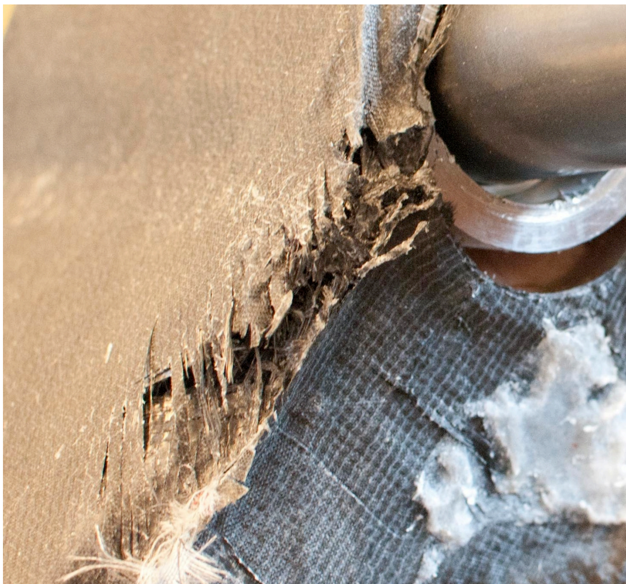
Figur 9-24: Nærbilde av bruddet på venstre side. Man ser her at bruddet først og fremst har forekommet i lag 2, som har en fiberretning som står nesten vinkelrett på kraftretningen. Fibrene har her blitt dratt fra hverandre, og dermed har lag 1 som er nesten parallelt med kraftretningen blitt delaminert. (Foto: O. A. Skjong)
