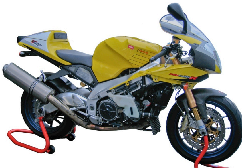
Figur 1-8: "Aprilia RSV Mille R med twin spar ramme. Aprilia designet faktisk rammen først på denne modellen, og fikk bygget motoren etterpå. Allment kjent for gode kjøreegenskaper, til tross for at det var Aprilias første superbike." [15]
