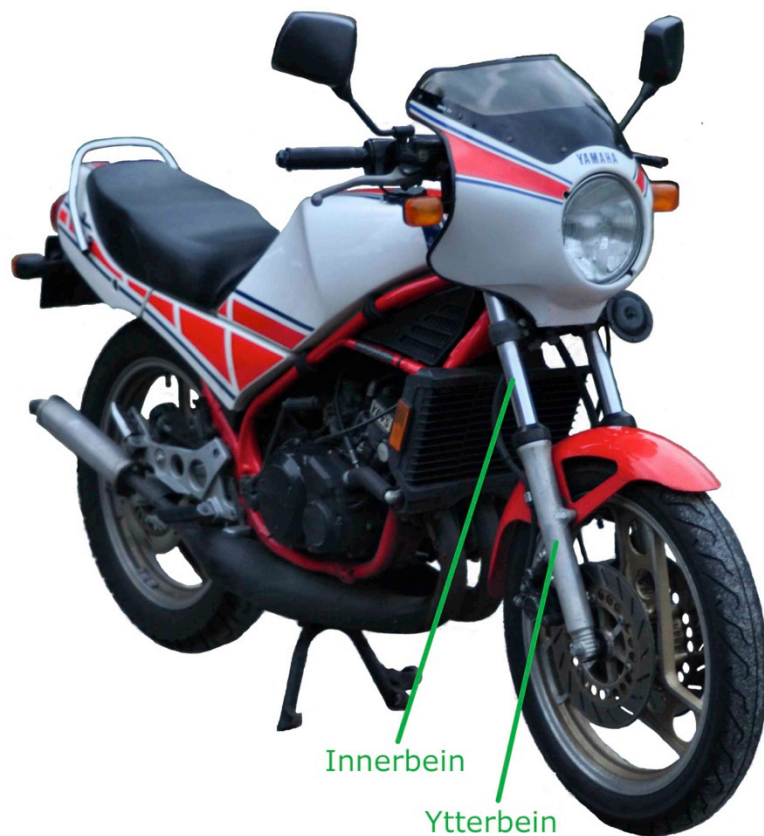
Figur 11-2: 1985 Yamaha RD 350 YPVS med konvensjonell dempegaffel. Her ser man at ytterbeina sitter nederst på dempegaffelen mens innerbeina er festet i styrebroene. (Foto: O. A. Skjong)
