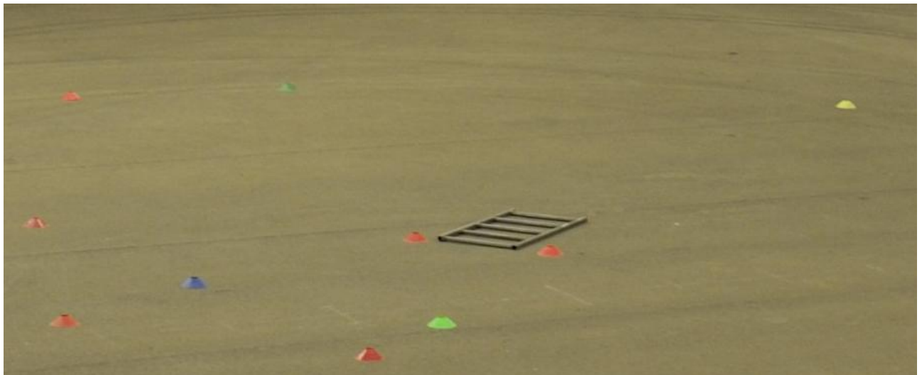
Figur 18: Viser det illustrerte vaskebrettet fra testkjøringen med kjegler som markerer hinderet for testsjåføren.[Foto: H.O. Krog]
