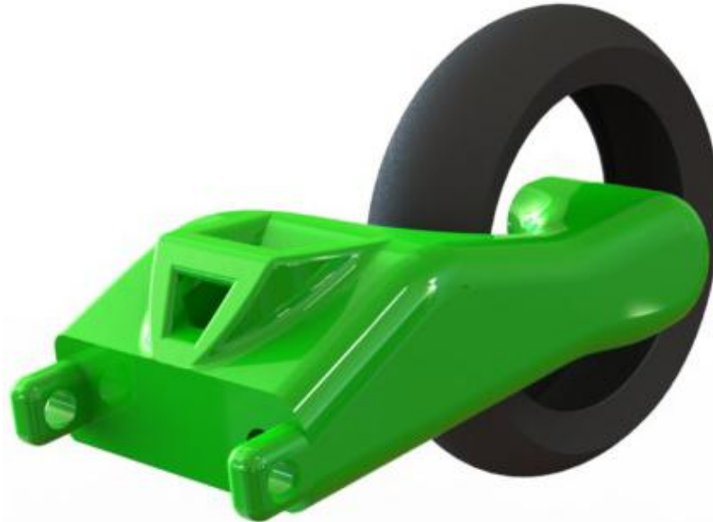
Figur 12: Viser en tidlig svingarmskonstruksjon, hvor bakhjulet illustreres med et dekk og svingarmens farge er valgt for tydelig å kunne vise formen av konstruksjonen i rapporten.
