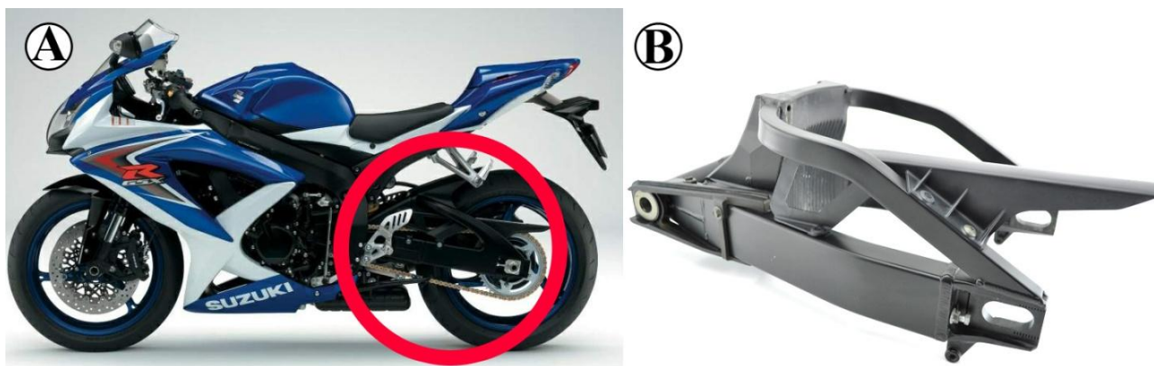
Figur 4: A viser referansemotorsykkelen brukt i tidligere arbeid. B viser svingarmen til denne motorsykkelen.[6].
