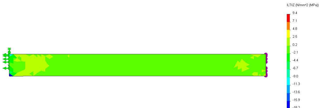
Figur 59: Viser at de interlaminære spenningene over alle lag, er mellom 9MPa og -18MPa.
