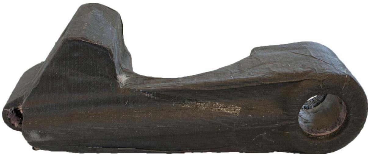
Figur 75:[27]. Viser ferdig produsert svingarm nummer 1, hvor ujevnhetene i fiberduken hovedsaklig kan sees på langsiden av svingarmen.
