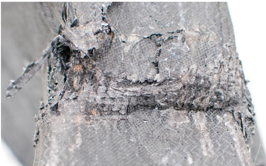
Figur 80:[27]. A viser bruddsprekken på oversiden av svingarmen, og det er vanskelig å kunne bestemme en bestemt bruddårsak. B viser langsiden av svingarmen, som illustrert i Figur 79, og man kan se at sprekken har vokst relativt rett nedover i profilet.
