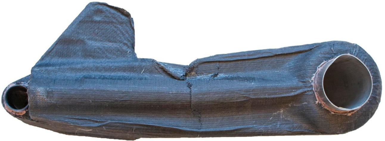
Figur 79:[27]. Viser svingarmen etter en påført maksimal last på 1774 kg.
