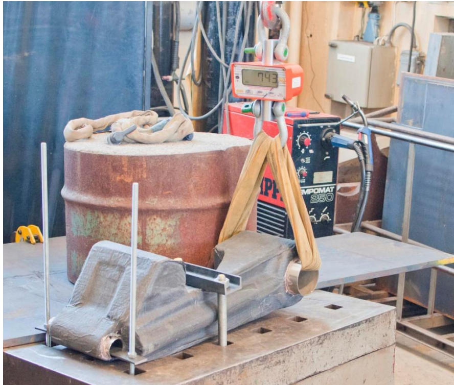
Figur 78:[27]. Viser hvordan svingarmen ble fastspent ved testen. Den er her boltet fast til et massivt bord, hvor det så er lagt på ekstra vekt i form av et sementlodd og jernplate. Bildet er tatt under belastning, og lastsellen viser her 743 kg.
