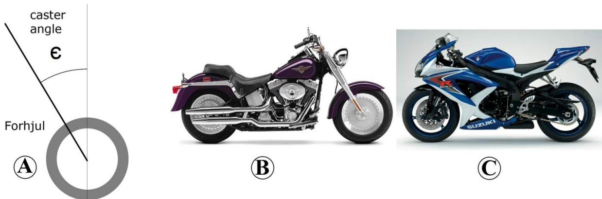
Figur 43: A viser hvordan caster angle for forstillingen er definert. B og C viser den karakteristiske forskjellen mellom en cruiser og en racing motorsykkel.[6, 18].
