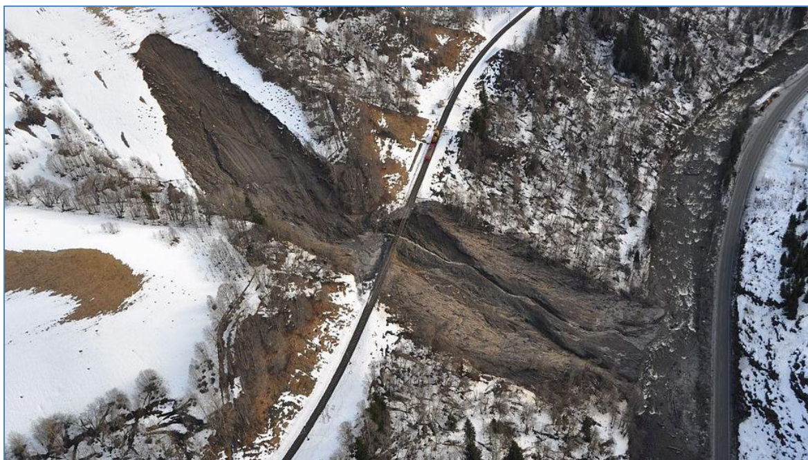
Figur7.4 Et enormt jordras på Dovrebanen i Sør-Trøndelag. En EPS-løsning ble ikke valgt (O. J. Kjellmark, 2012).
