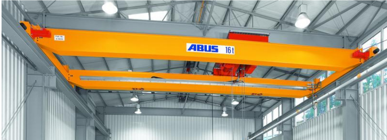
Figur 4: Bilde av en toppkjørende løpekran fra ABUS Crane Systems. (17) Det vises at kranbrua består av to dragere og at bruvognene kjører oppå kranbanebjelkene. Bildet antyder at denne kranen har en maksimalt tillatt last på 16 tonn.
