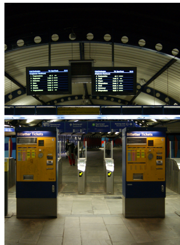
Bilde 89 : Plasseringen av billettautomater, skjermer og kontrollpunkter er ikke i samspill og ødelegger for flyten av mennesker og gjør det vanskelig for blant annet svaksynte, blinde og rullestol brukere å passere. Håkon Røer Ellingsen
