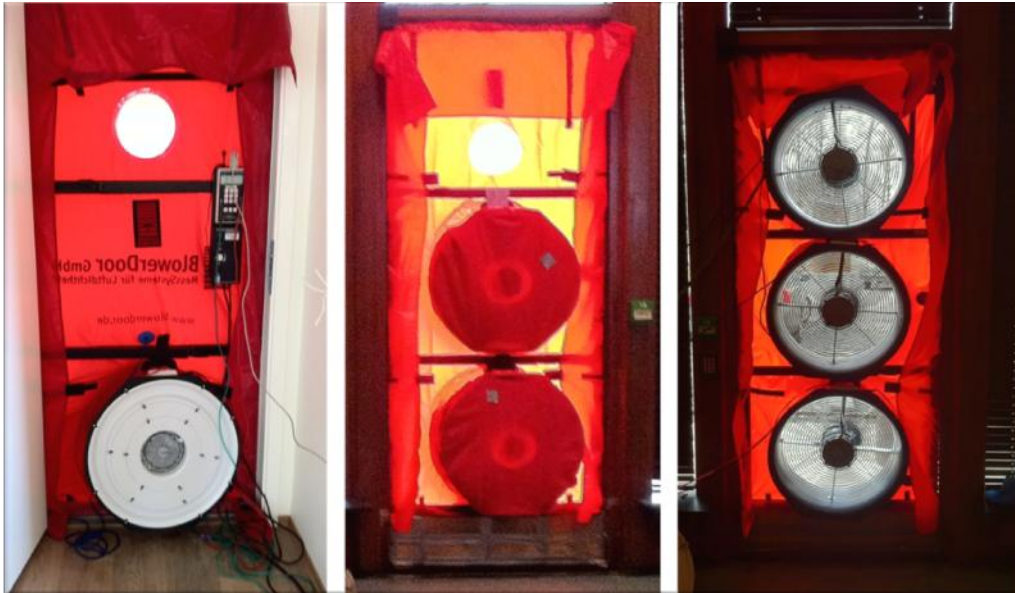
Figur 7.1: Forskjellig oppsett med Blowerdoor.
