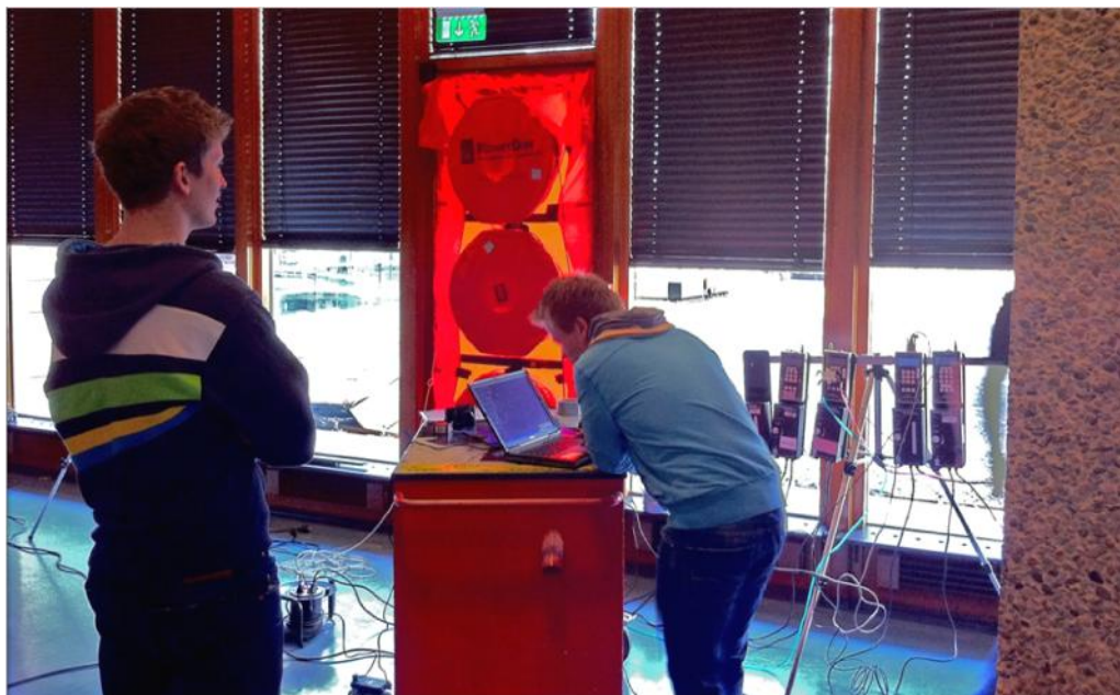
Figur 7.2: Noe av utstyret vi brukte til å måle et bygg på 43000 m 3
