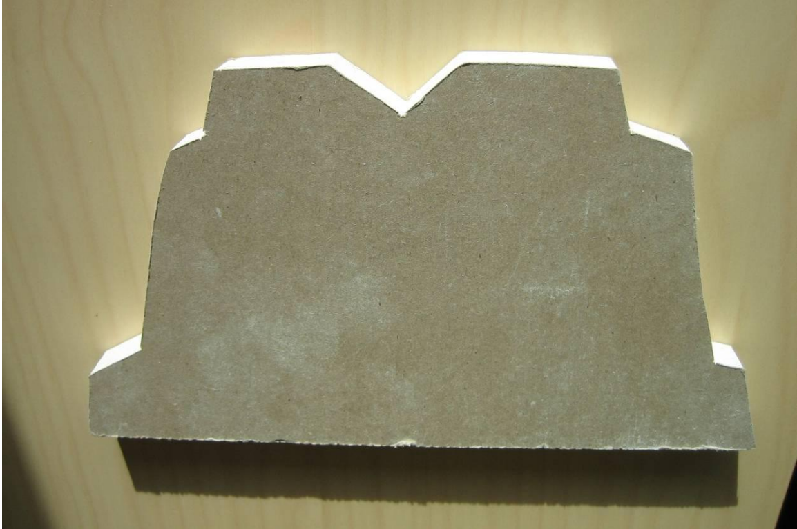
Figur 3.3: Tilpasningsbit av gips som er montert i åpning mellom TRP-plater og yttervegg for så å fuge rundt.
