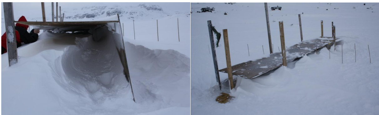
Figur 27: Stor oppfylling etter sterk vind. Ensidig overheng 123 cm. Se graf for L_O.
