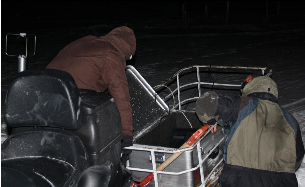
Figur 20: Oppsetting av medbrakt værstasjon og datalogger i tett kasse.
