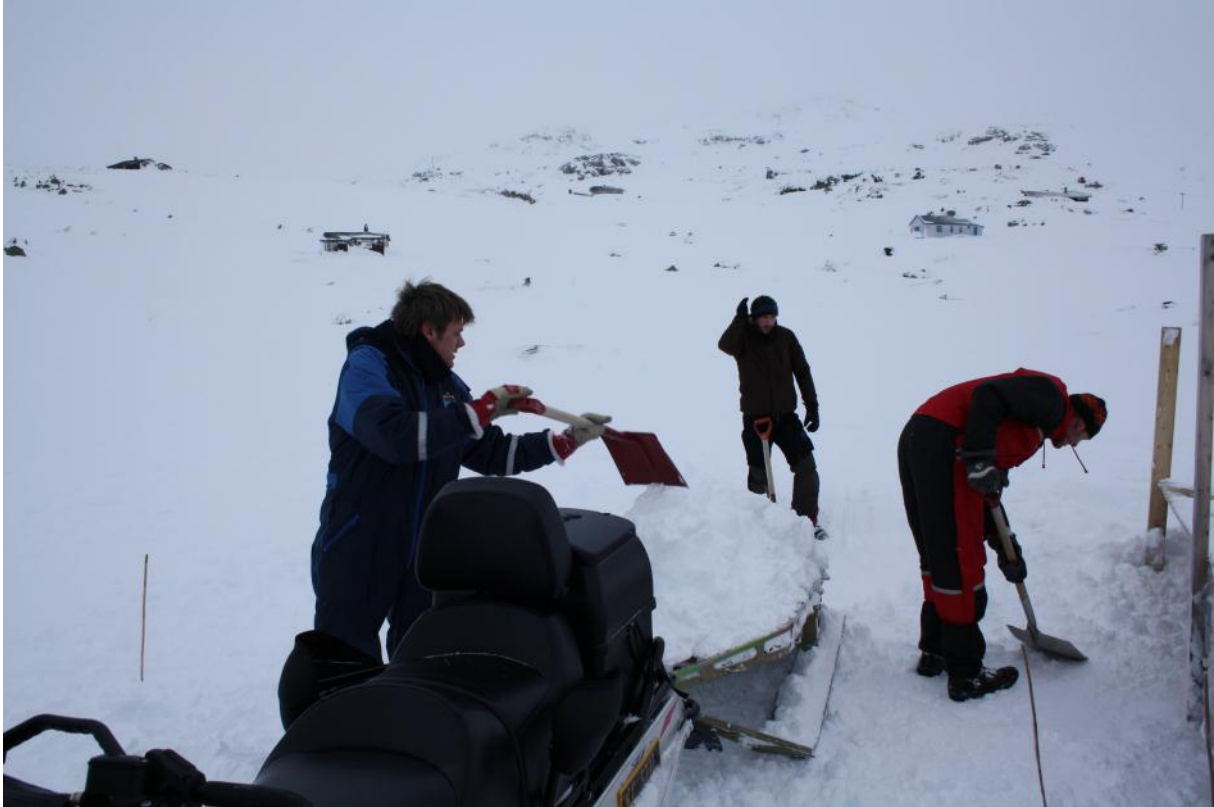
Figur 12: Skalamodell tømmes for snø for å gjøre nye målinger. Snøen fraktes langt nok til at den ikke vil forstyrre de nye målingene.
