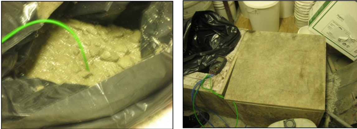
Figur 18 Måling av temperaturutvikling i herdekasse
