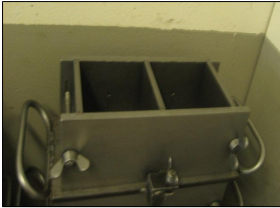
Figur 17 Støping av prøvestykker
