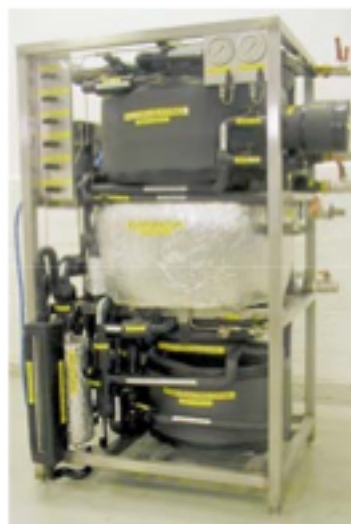
Prototype av CO 2 varmepumpe for varmtvann og romoppvarming (stene, 2004)
