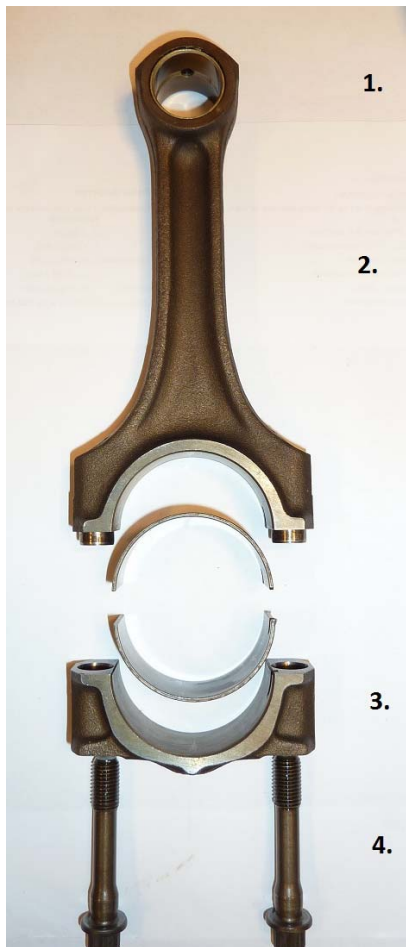
Figur 2.6 Oppbygning av en veivstang.
