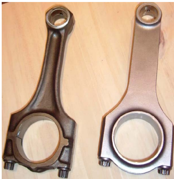
Figur 2.14 Original veivstang til venstre og alternativ til samme motor med annet profil og materiale til høyre.
