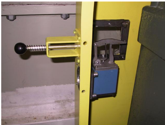
Figur 3-20: Mekanisk utløser, løsning 2. Bildet til venstre: med hydraulisk retningsventil og spak for resetting. Bildet til høyre: med elektrisk mikrobryter [38].
