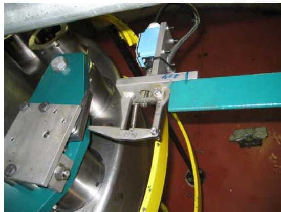
Figur 3-20: Mekanisk utløser, løsning 2. Bildet til venstre: med hydraulisk retningsventil og spak for resetting. Bildet til høyre: med elektrisk mikrobryter [38].
