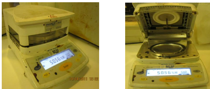
Figur 3.1.4: konsistens måleinstrument for konsistens av masse
