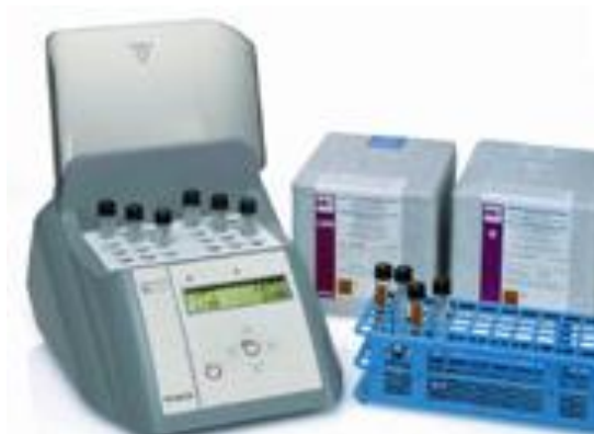
Figur 3.2.1: desintegrator for lesing av KOF i mg/l.
