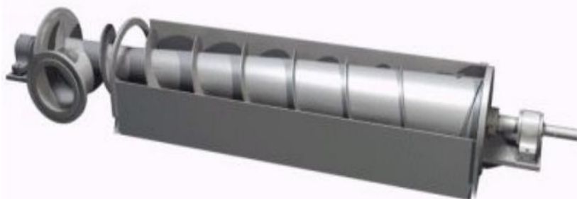
Figur 2.4.5: Skruetransportør i vaskepressen. [ref. 17]
