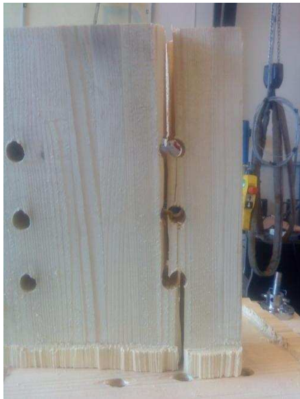
Figur 6.12 Oppsprekking langs dyblene
