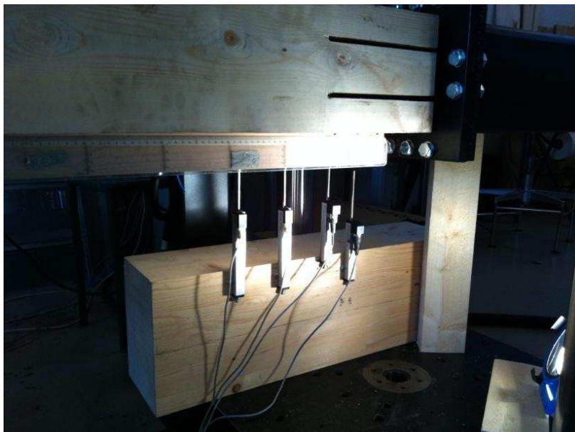
Figur 4.9 Oppsett av deformasjonsmålerne for forbindelse B1, B2 og B3
