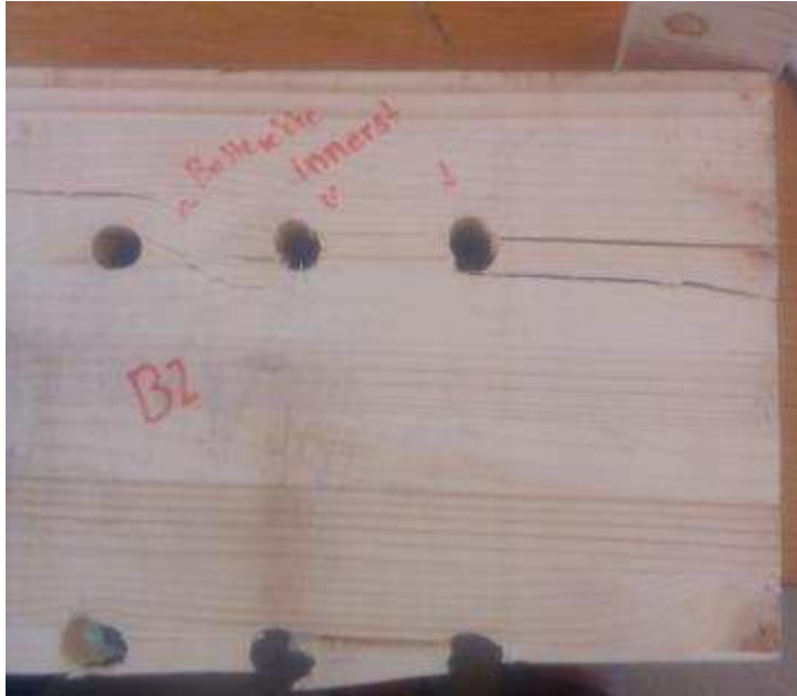
Figur F7. Simulerer oppsprekking langs dyblene
