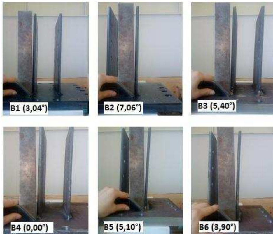
Figur 6.17 Bøyning av de insslissede stålplatene. Vinkelendringen hos B1= 3,04°, B2= 7,06°, B3= 5,40°, B4= 0,00°, B5 = 5,10°, B6 = 3,90°.
