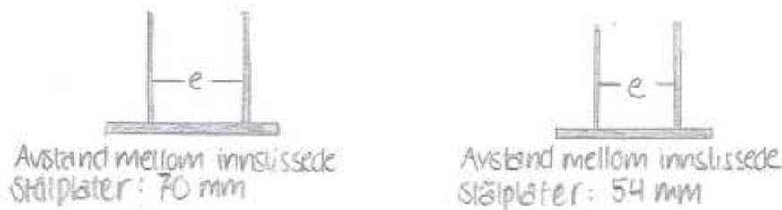
Figur C2 Støtteplate med to innlissede stålplater
