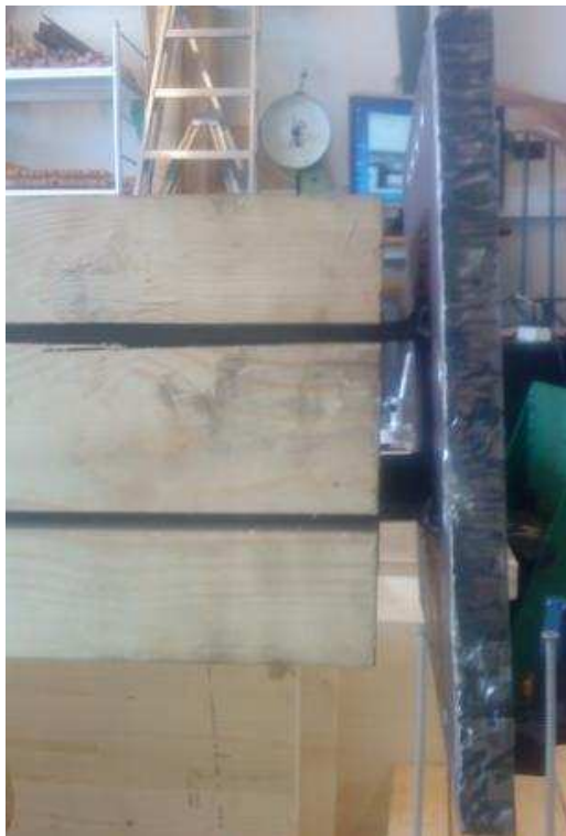
Figur F6. De innslissede stålplatene fikk en vinkelendring
