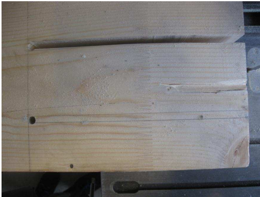
Figur 9.2 Åpningen på slissene. Disse kan være forskjellig på grunn av unøyaktig oppmåling og skjæring.
