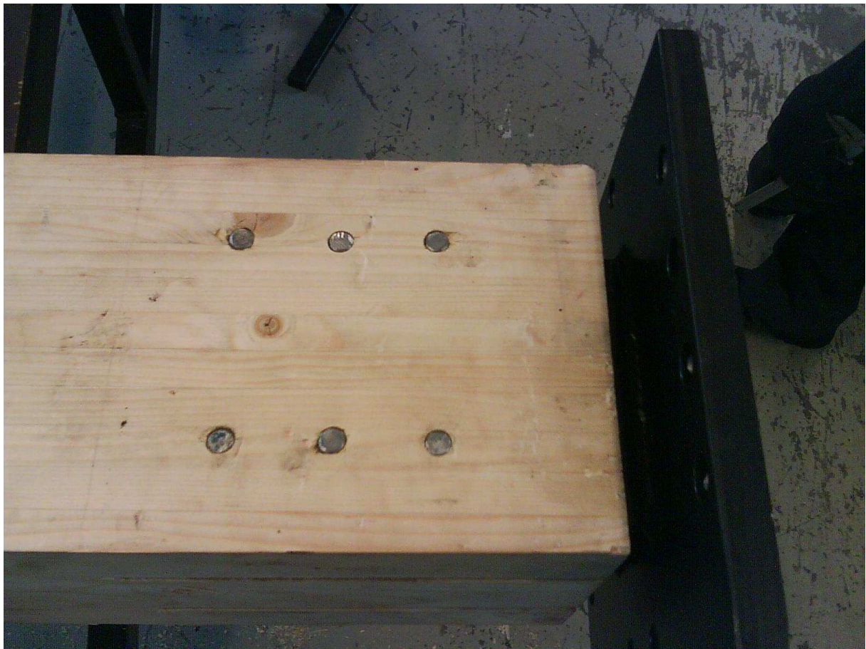
Figur 9.1 Virkesfeil i trevirke. Rett ved den ene dybelen er det en kvist som kan ha vært med på å påvirke kapasiteten til forbindelsen.
