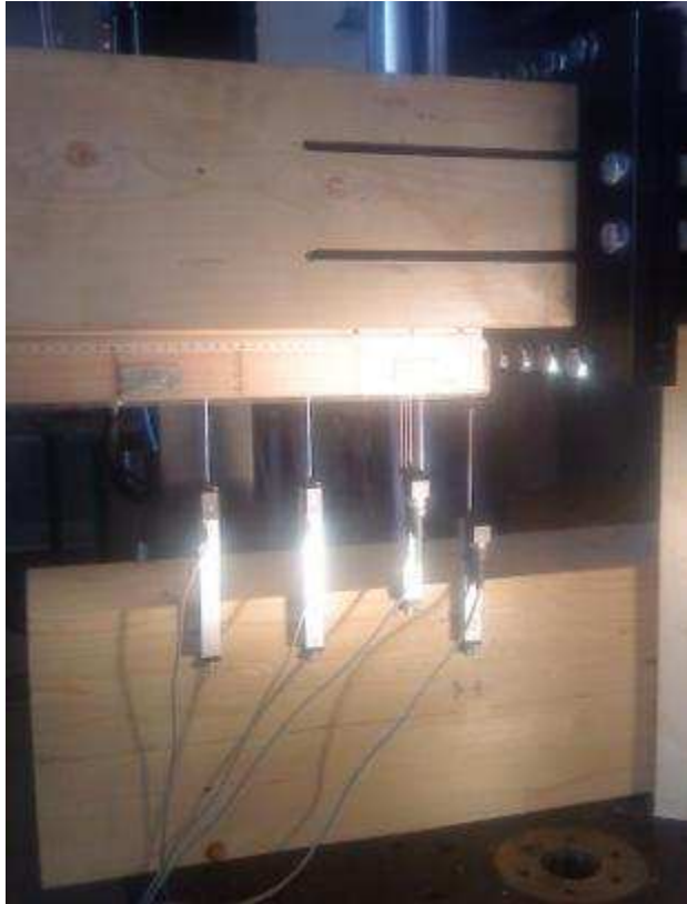
Figur F5. Testoppsett 1 med deformasjonsmålere
