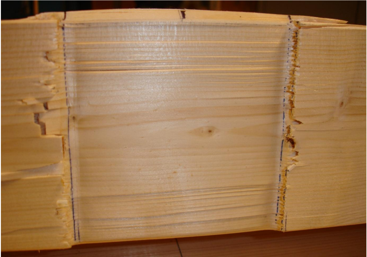
Figur 43 Typisk inntrykning i limtrebjelke G13.
