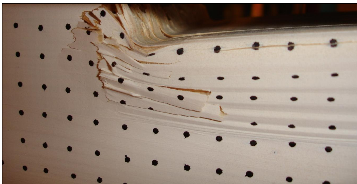
Figur 25 "Forsvinning" av prikker illustrert på limtrebjelke G19. Hengekøyeeffekten er tydelig.
