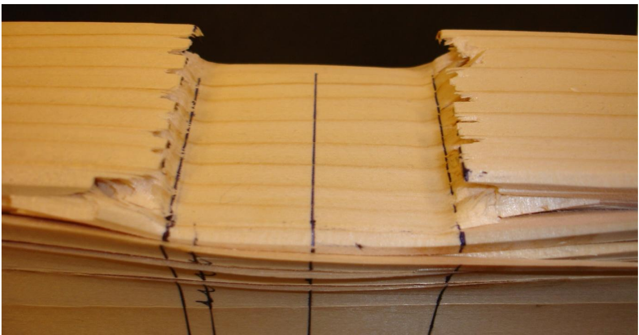
Figur 47 Typisk brudd i heltrebjelke (G26).
