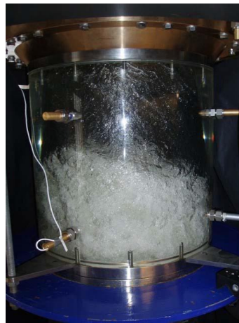
Figur 12; a) Rheinmannsfrekvens, b) Dellast der man ser at rotoren får for lite vann slik at det skapes luftbobler i sugerøret. c) Nært området for best virkningsgrad. [18]
