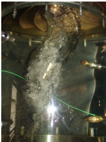
Figur 12; a) Rheinmannsfrekvens, b) Dellast der man ser at rotoren får for lite vann slik at det skapes luftbobler i sugerøret. c) Nært området for best virkningsgrad. [18]
