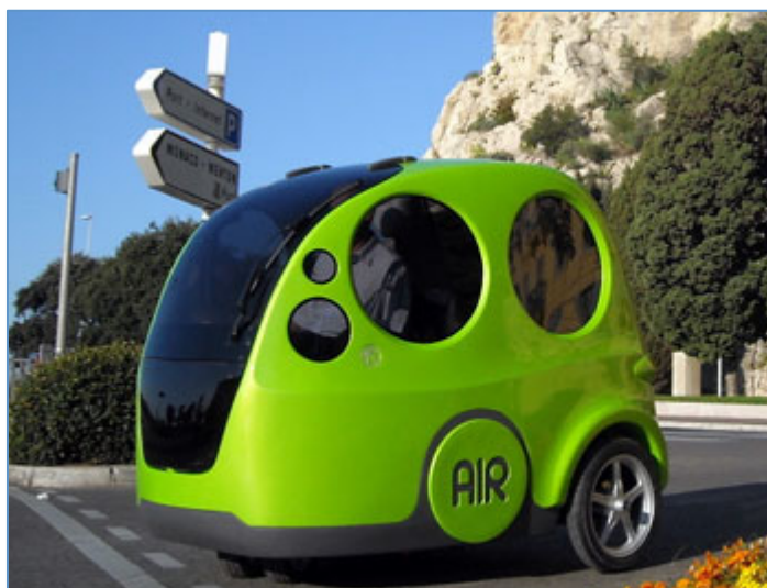
Figur18: MDI utvikler biler som kan drives frem av luft under trykk. Her vises en av de aktuelle modellene, Air Pod (MDI 2011).
