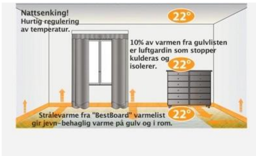
Figur 73 Best Bord varmelist for vannbåren varme. Varmelistene samt varmestrålene vises i oransje.
