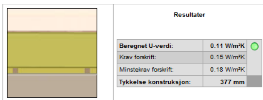
Figur 49. Beregning av u-verdi til etasjeskiller mellom kjeller og 1. etasje utført ved hjelp av beregningsprogram.
