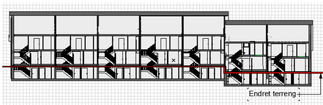
Figur 35. Snitt av boliger på nordøstside etter terrengendring. Terreng vises som rød strek. (Fig. N. Aa. Tangen)
