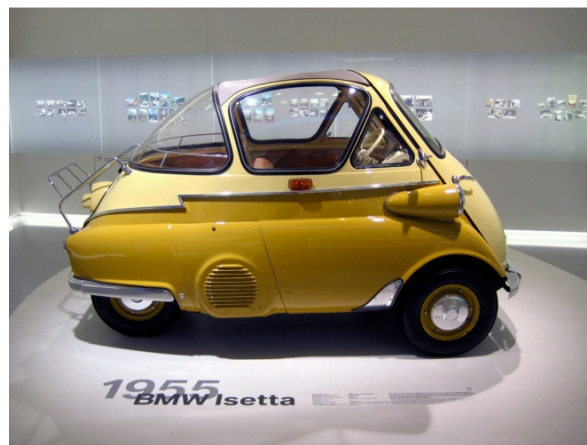
Figur 0-6: BMW Isetta med motorsykelmotor og to tett plasserte bakhjul [eget foto].
