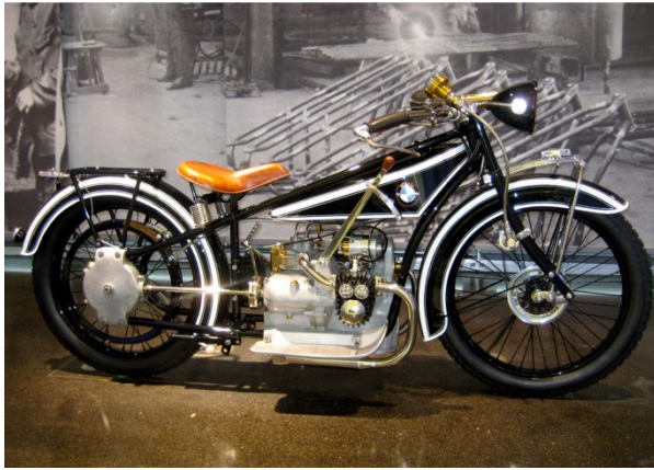
Figur 0-7: BMWs første motorsykkel fra 1923, med boxermotor og kardangoverføring [eget foto].
