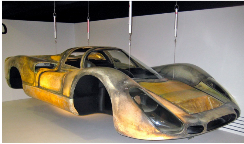
Figur 0-12: Glassfiberkarosseri til eldre Porsche brukt i motorsport [eget foto].
