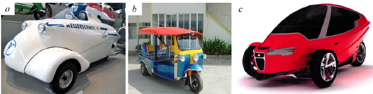
Figur 2-7: Bildemontasje. a) Eksempel på tadpole; Messerschmitt [eget foto]. b) Eksempel på delta; Tuk-Tuk [9]. c) Tidligere formstudieprosjekt ved UMB for en hurtiggående versjon av Dolphin basert på tadpole-prinsippet [10].
