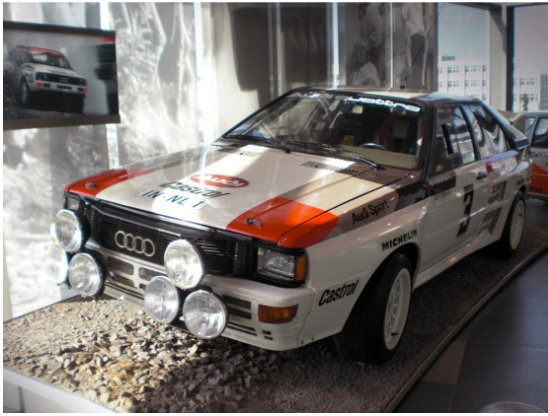
Figur 0-19: Audi Sport Quattro gjorde rent bord da den debuterte i rally i 1981 takket være det nye firehjulstrekkssystemet [eget foto].
