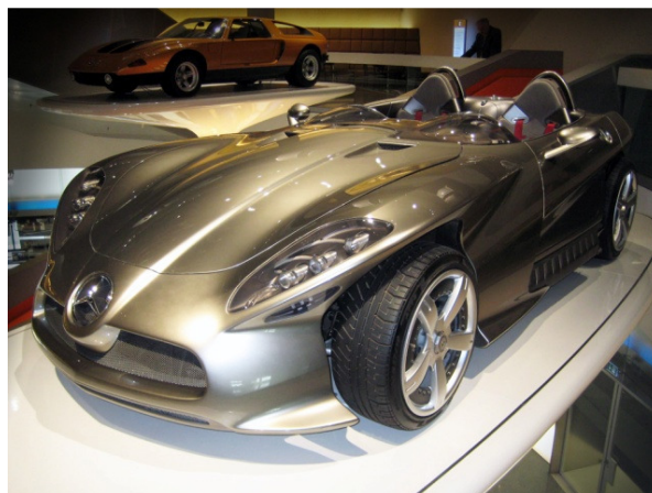
Figur 0-16: Konseptbilen F400 Carver med aktiv camberjustering. De ytterste hjulene lener seg innover i svingen [eget foto].
