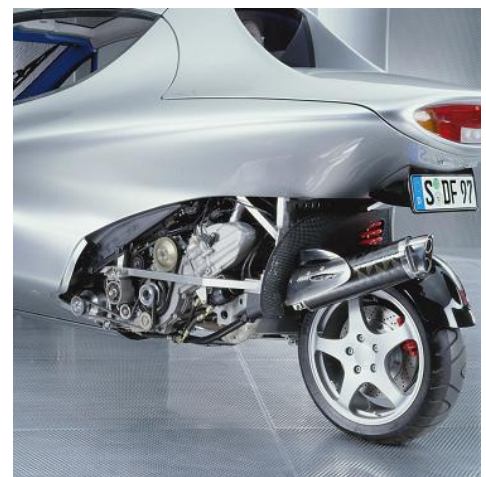
Figur 0-15: Bakhjulsoppheng med 1,6 L motor fra MB A-klasse [52].
