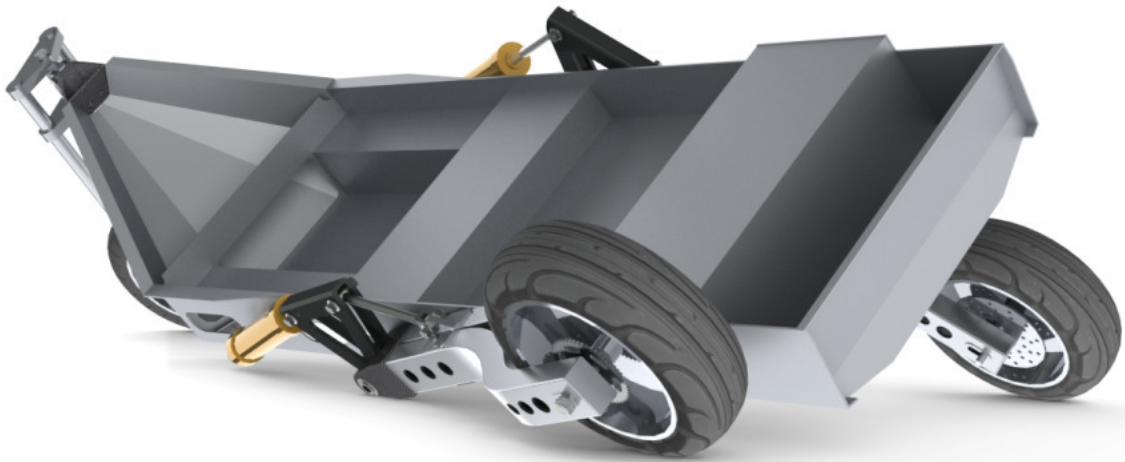
Figur 7-3: Kjøretøyet med 45° tiltevinkel. Svingarmen på den ene siden roterer med en større vinkel enn den andre i motsatt retning for å beholde bakkeklaringen. Rammens innside indikerer bla. sitteplassene for sjåfør og passasjerer, fotbrønn og bagasje plass.
