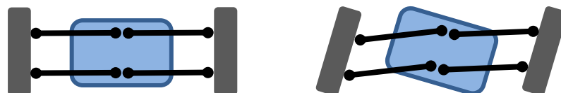
Figur 2-19: Prinsipp for bakhjulsoppheng med tversgående bærearmer med tilnærmet felles opphengspunkt i senter.
