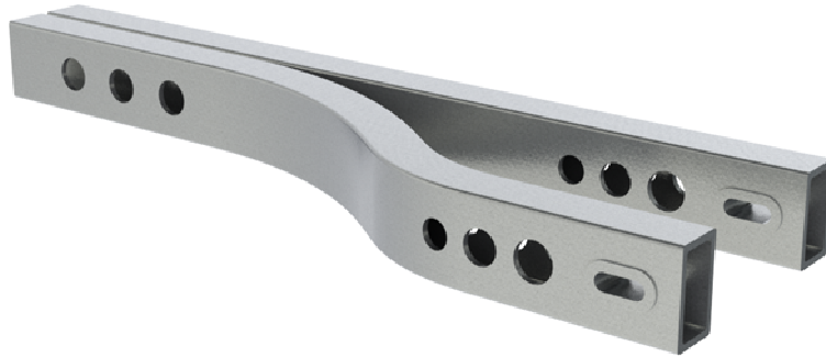
Figur 6-47: Svingarmen består av to standard firkantprofiler som kappes, freses og bøyes. Mulighetene for bøying, og spesifikke angivelser, er fortsatt noe usikkert.
