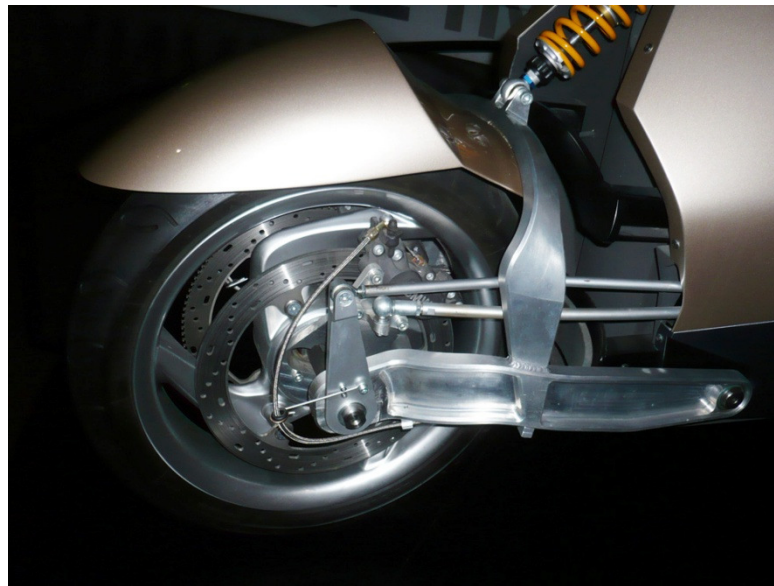
Figur 2-31: Eksempel på navstyring, hentet fra konseptkjøretøyet CLEVER [eget foto].
