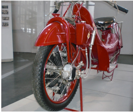
Figur 0-3: Motorsykel med framhjulstrekk og integrert navmotor [eget foto].
