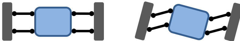
Figur 2-17: Prinsipp for bakhjulsoppheng med tversgående bærearmer.
