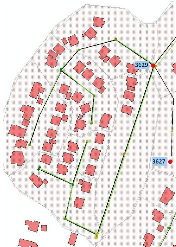
Figur 91: Området over Veumdalen nord-vest, Ambjørnrød, med to kummer som får en oppstuvning over bakkenivå. Kum nummeret er vist på figuren.
