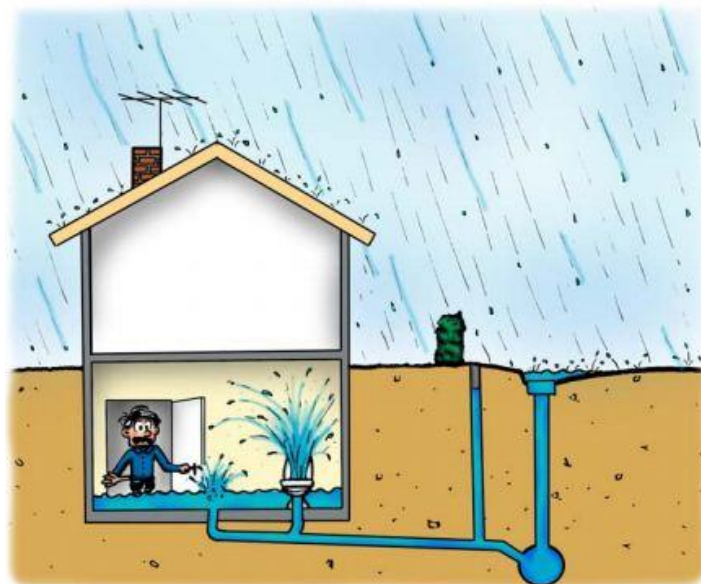
Figur 4: Skader som følge av oppstuvning i fellesavløpssystem (Fredrikstad 2007) Illustrasjon av Mathias de Maré.
