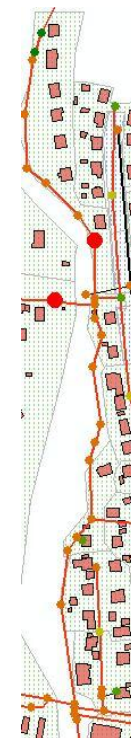
Figur 88: Figuren over viser utvikling i antall kummer som stuver opp på marknivå for et regn med 10-, 20- og 50-års gjentaksintervall med et klimatillegg på 50 %. De røde prikkene viser de aktuelle kummene som får oppstuvning over topp kum. Det kritiske nivået er flyttet opp fra 75 cm til markoverflaten, da ledningstrekket går langs Veumbekken som er det laveste punktet i området. Husene som er tilknyttet hovedledningen ligger derfor en del høyere i terrenget.
