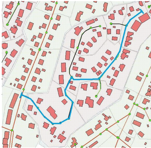
Figur 67: Viser ledningsstrekket som er vist i profil i Figur 68 nedenfor. Dette er del av ledningsstrekket som er valgt ut med hensyn på oppstuvning vist i Figur 66 over, for nærmere gjennomgang.
