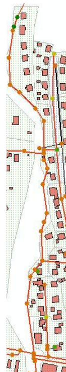
Figur 88: Figuren over viser utvikling i antall kummer som stuver opp på marknivå for et regn med 10-, 20- og 50-års gjentaksintervall med et klimatillegg på 50 %. De røde prikkene viser de aktuelle kummene som får oppstuvning over topp kum. Det kritiske nivået er flyttet opp fra 75 cm til markoverflaten, da ledningstrekket går langs Veumbekken som er det laveste punktet i området. Husene som er tilknyttet hovedledningen ligger derfor en del høyere i terrenget.
