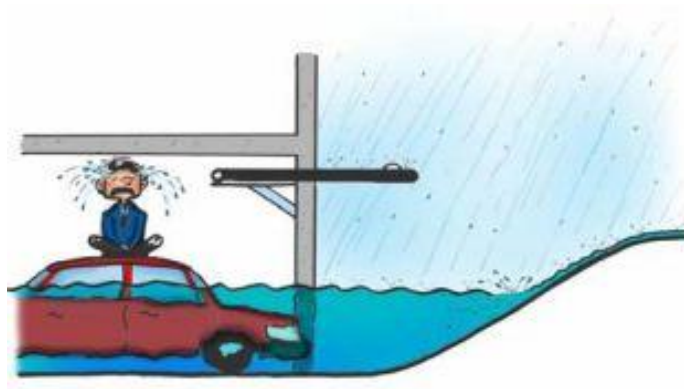
Figur 6: Skader som følge av oppstuvning til over bakkenivå etter overskredet kapasitet i avløpsystem. Overflateavrenningen følger terrenget og kan føre til skade på bygninger, bruksarealer og infrastruktur. (Fredrikstad 2007) Illustrasjon av Mathias de Maré
