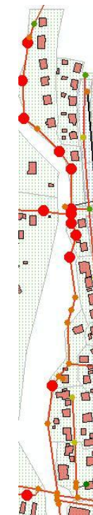
Figur 88: Figuren over viser utvikling i antall kummer som stuver opp på marknivå for et regn med 10-, 20- og 50-års gjentaksintervall med et klimatillegg på 50 %. De røde prikkene viser de aktuelle kummene som får oppstuvning over topp kum. Det kritiske nivået er flyttet opp fra 75 cm til markoverflaten, da ledningstrekket går langs Veumbekken som er det laveste punktet i området. Husene som er tilknyttet hovedledningen ligger derfor en del høyere i terrenget.
