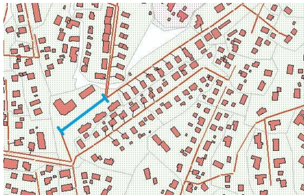
Figur 93: Det merkede ledningsstrekket blir brukt i følsomhetsanalysen. Punktet er valgt ut på grunnlag av tidligere resultater, hendelser samt beliggenhet med store oven foreliggende avrenningsarealer vist i Figur 94.
