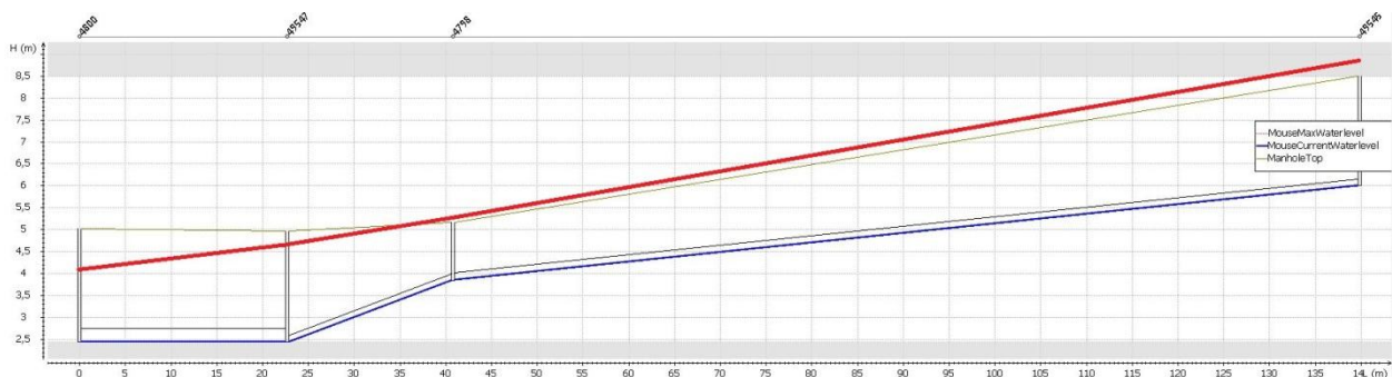
Figur 80: Viser ledningsstrek fra Figur 79 der det blir oppstuvning til overflaten i boligfeltet. Dette ledningsstrekket starter fra hovedledningen fra bekken, og strekker seg innover i boligfeltet.
