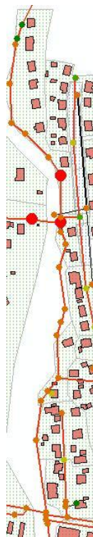
Figur 88: Figuren over viser utvikling i antall kummer som stuver opp på marknivå for et regn med 10-, 20- og 50-års gjentaksintervall med et klimatillegg på 50 %. De røde prikkene viser de aktuelle kummene som får oppstuvning over topp kum. Det kritiske nivået er flyttet opp fra 75 cm til markoverflaten, da ledningstrekket går langs Veumbekken som er det laveste punktet i området. Husene som er tilknyttet hovedledningen ligger derfor en del høyere i terrenget.
