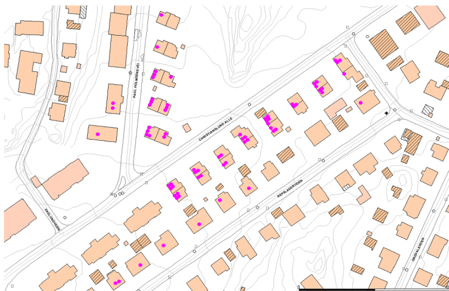
Figur 65: Kjelleroversvømmelser i Christiansluds allé og omegn som følge av ekstremregnet 07.09.2002. De lilla punktene angir kjelleroversvømmelser. I bygninger der det er flere lilla punkter er bygget delt inn i flere boliger, og dermed flere kjellere. Figuren er brukt til sammenligning med resultatene i denne oppgaven for samme område, vist i Figur 62.
