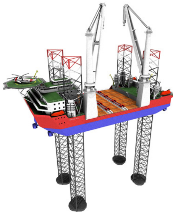
Figur 37: Jackup-fartøyet Service Jack er et flerbrukskonsept som kan benyttes både til offshore vindkraft og i oljesektoren (Master Marine ASA 2009a)
