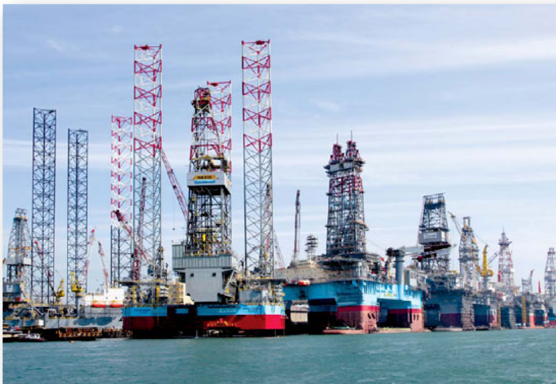
Figur 186: Masseproduksjon av halvt nedsenkbare plattformer og jackup-rigger (Keppel Corporation 2008)
