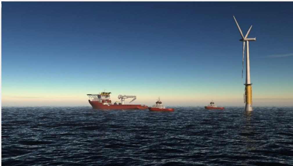
Figur 30: Tauging av Hywind 2,3 MW demonstrasjonsturbin med én AHTS og to taubåter (StatoilHydro 2009)
