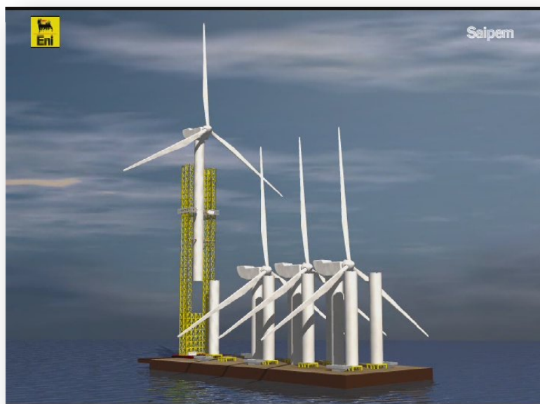
Figur 33: Løftekonseptet Turbine Roll & Lift av Saipem SA (Goalabré et al. 2006)
