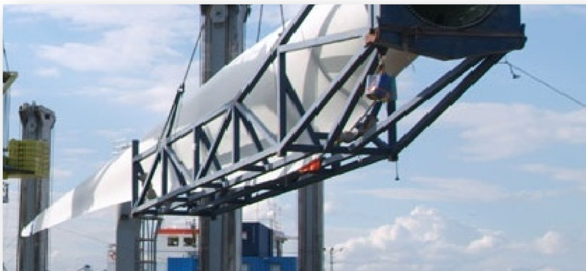
Figur 59: Løft av turbinblad i beskyttende transportkonstruksjon (A2SEA AS 2009b)
