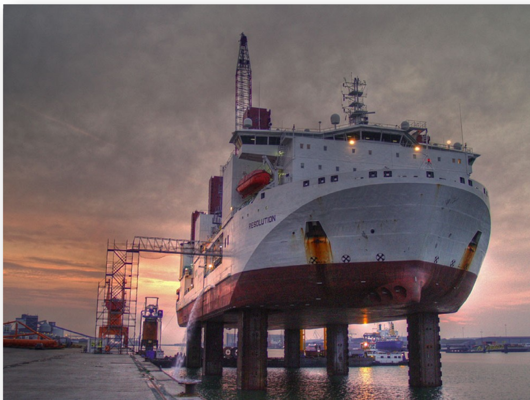
Figur 27: Spesialfartøyet MV Resolution (MPI Offshore 2009b)
