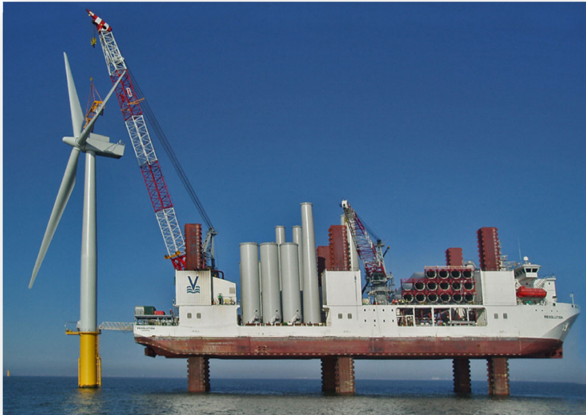
Figur 28: Skipet M/V Resolution har en lastekapasitet på nærmere 9000 tonn (MPI Offshore 2009b)
