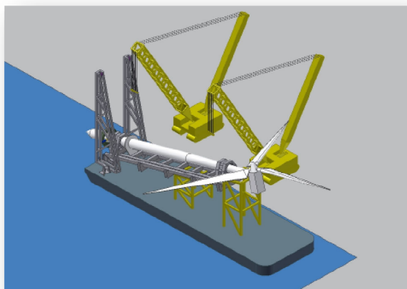
Figur 198: Horisontal lossing av komplett vindturbin (Bland 2004)
