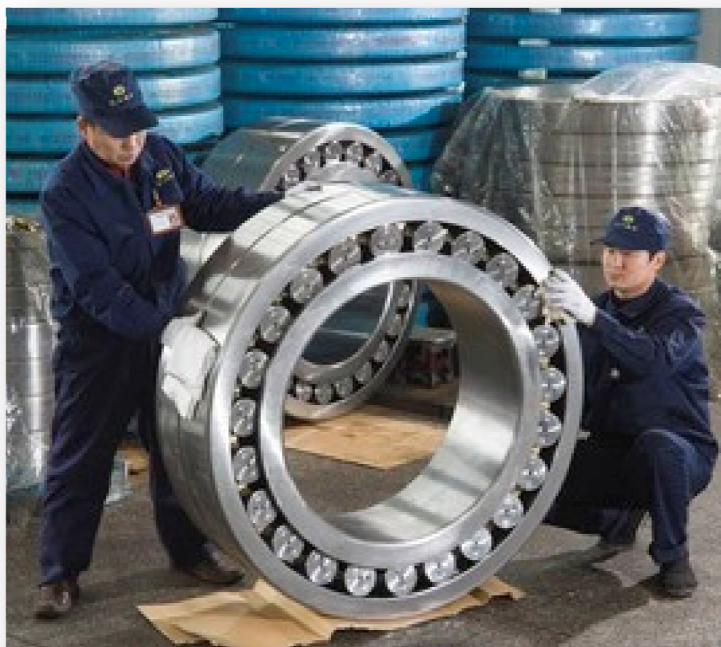
Figur 52: Større sfærisk rullelager til bruk i brokonstruksjoner og bygninger (Luoyang Huigong Large-size Bearing Manufacturer Co 2009)
