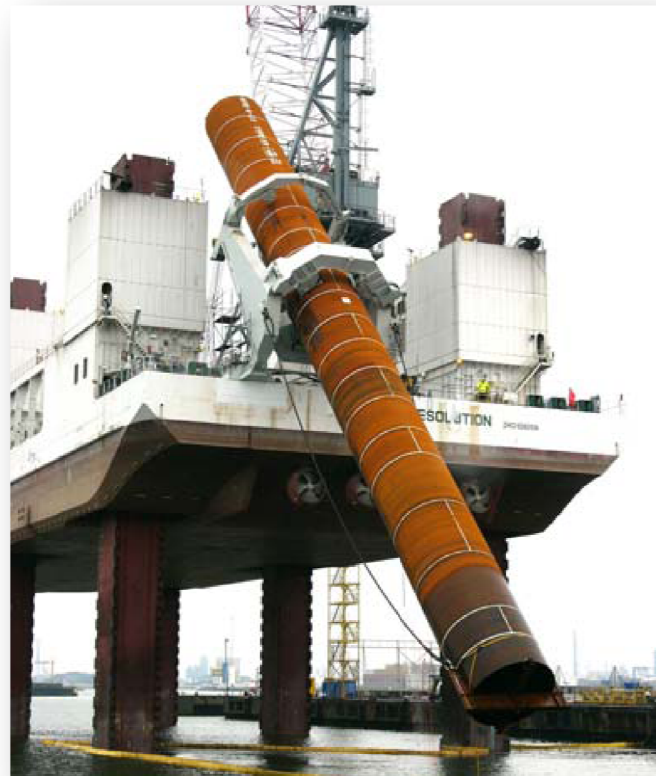
Figur 53: Pælehåndteringsverktøyet til GustoMSC (GustoMSC 2008a)
