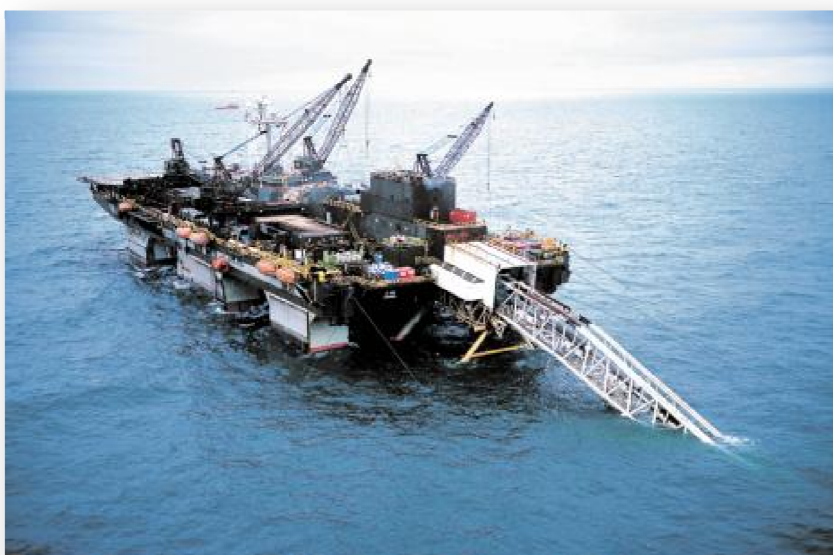
Figur 194: Acergy Piper har en avansert sammenstillingslinje for legging av gassrørledninger på havbunnen (Hydro 2008)
