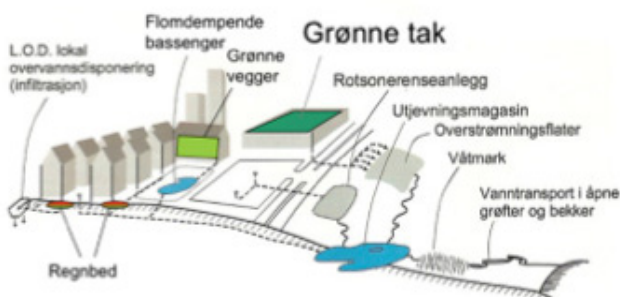
Figur 29: I et alternativt overvannssystem er grønne tak et av flere klimatilpassingstiltak som kan fordrøye overvann.
