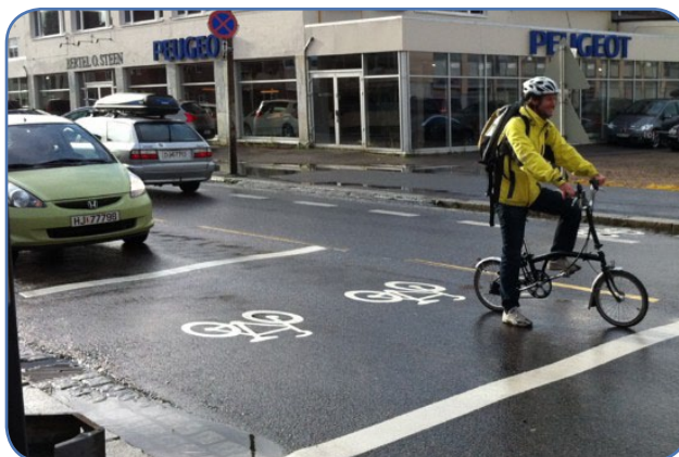
Bilde 27: SYKKELBOKSER I KRYSS I LILLESTRØM. Tiltaket slipper syklistene først fram i kryssene, og gir alle god sikt.
