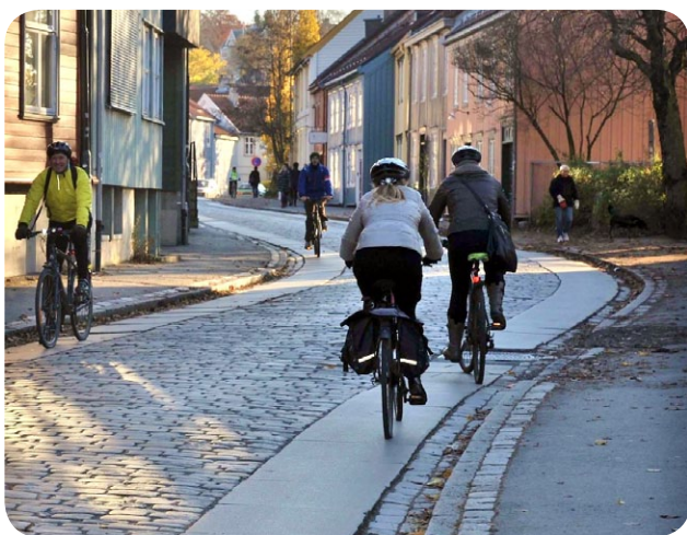
Bilde 56: BAKKLANDET-UTFORMING: Steinheller i sidene av kjørebane fungerer uttalt som sykkelfelt.
