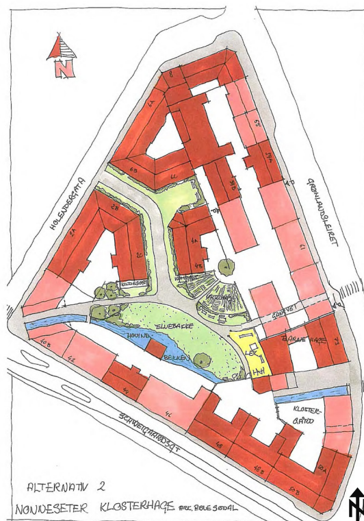
Fig 4.48 Plansmias alternativ 2 skiller seg fra alternativ 1 kun på at inngangen til kvartalet er plassert i Grønlandsleiret 62 og at bekken ikke er åpen gjennom gårdsrommene til Schweigaardsgate 48 a og b (GBF 2008:9).
