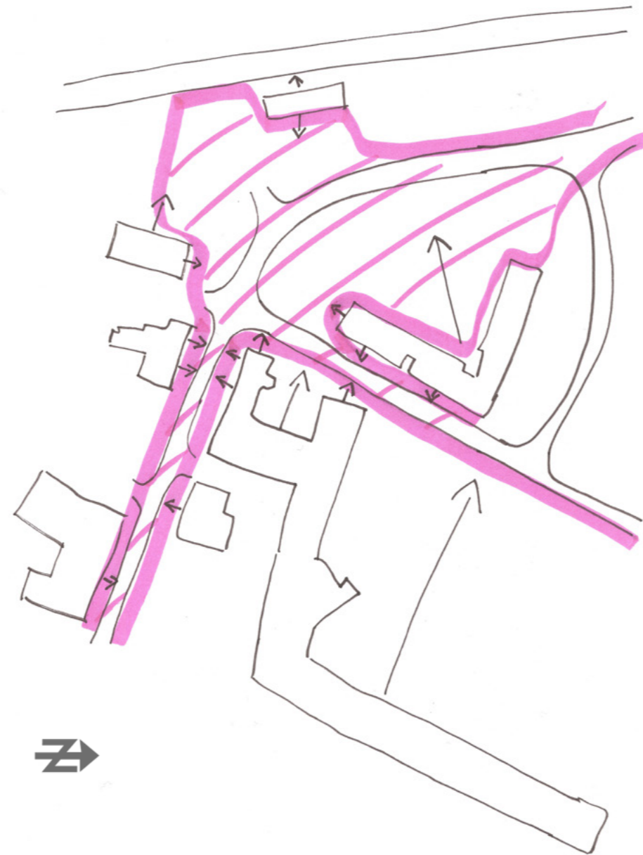
Skisse med piler som viser de viktigste fasadene mot Troforsvegen, innkjøringen til Trofors fra ny E6 og Industrivegen. Bruken av disse er viktig i forhold til hvordan byrommet oppleves, de må være orientert utover. den tykke streken markerer ytterkanten av det jeg oppfatter som sentrumsrommet i Trofors.
