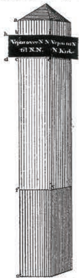
Fra a. til b. 6". Pladen f. i. d. e. 18" lang og 9" bred. Fra c. til f. 2 1/2 Alen. Fra f. til g. 1 1/2 Alen. Fra a. til f. 3 Alen og 3". Fra f. til k. 10". Stolpens Længde 4 Alen.
