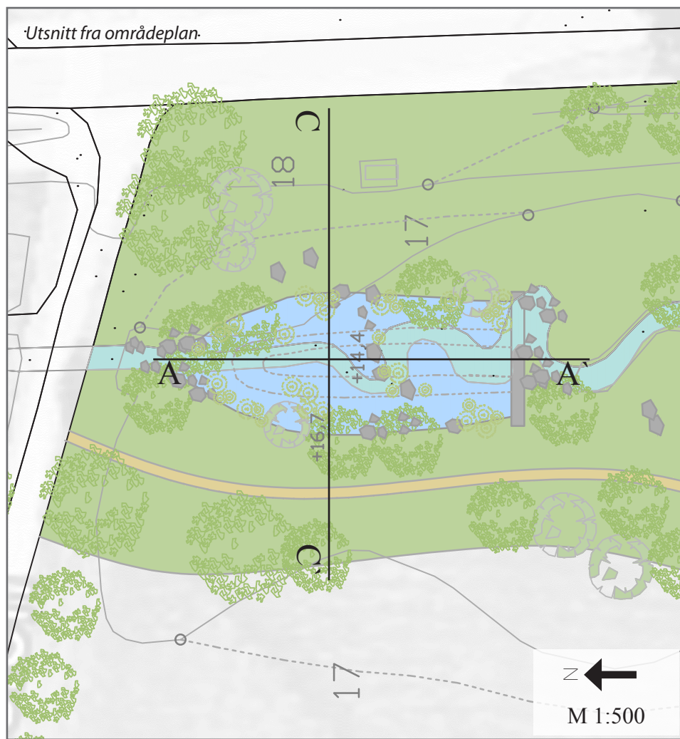
Figur 36: Illustrasjon av "tørr" dam ved flom i bekken. Ved stor vannføring i bekken, vil utløpskontrollen holde vann tilbake og fylle opp dammen. På denne måten fordrøyes vannet og flomtoppene slik at de gjør mindre skade videre nedstrøms i bekkeløpet.
