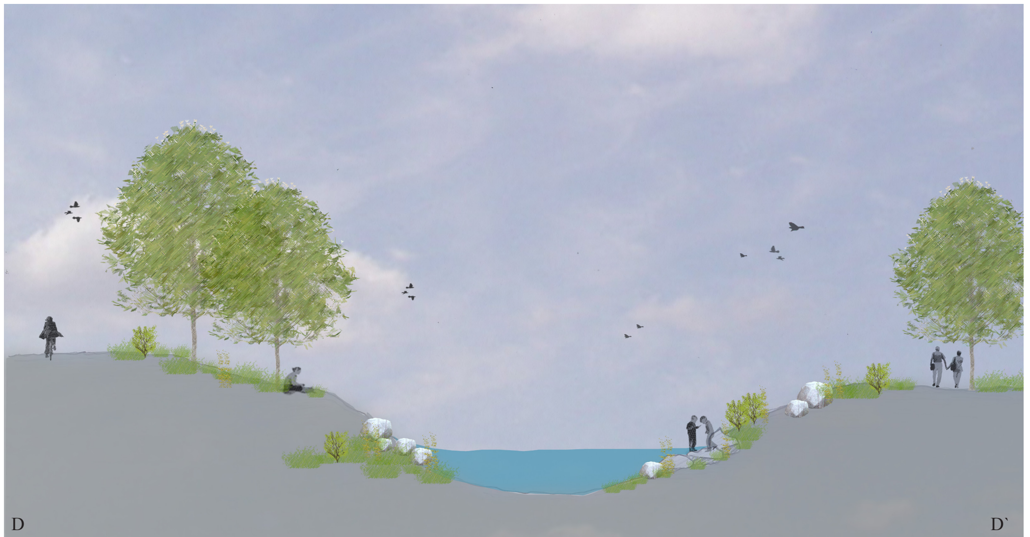
Figur 41: Illustrerende tverrsnitt (D til D' som vist i figur 37) som viser den "våte" dammen med permanent vannvolum. Utløp må dimensjoneres og formes slik at ønsket vannmengde oppholdes i dammen. Dammen har betydelig ekstra kapasitet for fordrøyning i volum over permanent vannstand. (Snittet er ment som illustrasjon og prinsipp og er ikke i målestokk).
