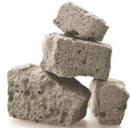
Illustrasjon nr. 38. Glasopor kan brukes som dreneringslag.
