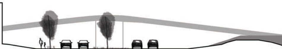
fig 4.29 Snitt Østre Rosten 1:500 Fire kjørefelt og ensidig fortau på baksiden av næringsbygg innbyr ikke til bruk for myke trafikanter.
