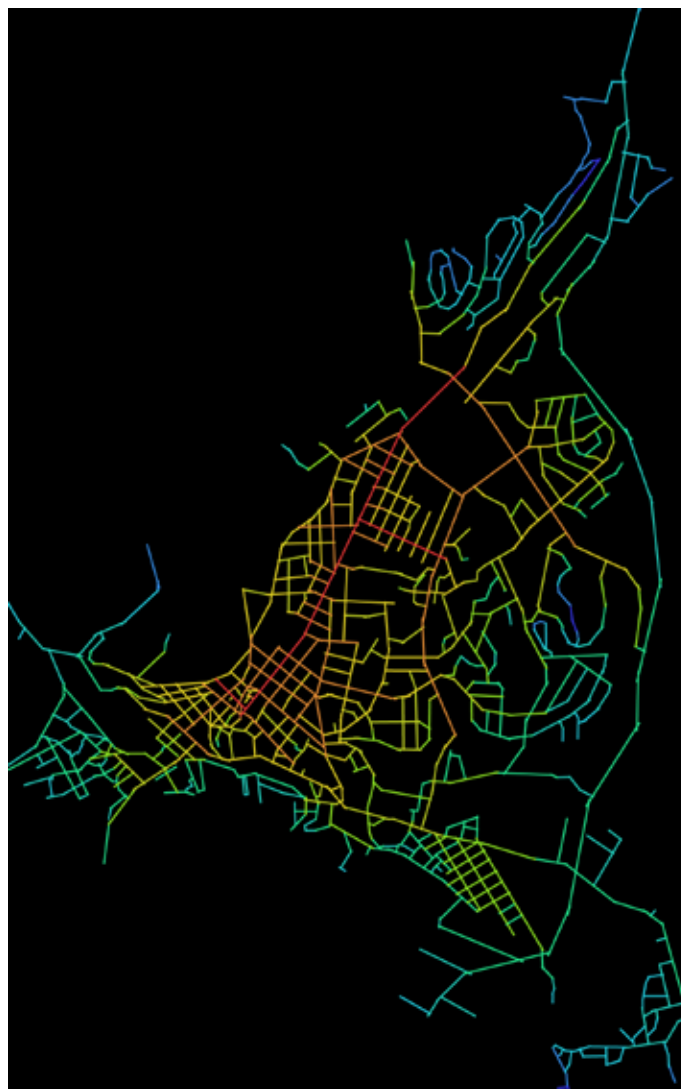
Figur 3.1b: Lokal integrasjon med radius 13, for dagens situasjon. Analysen beregner hvor langt man kan komme fra hvert enkelt rom i nettverket dersom kun tar et gitt antall steg. Antall steg er analysens radius. Med høy radius får man forhøyede verdier i midten av nettverket. Med lav radius får man færre rom med høye verdier, hvilket gjør det lettere å identifisere økte verdier rundt om i nettverket.
