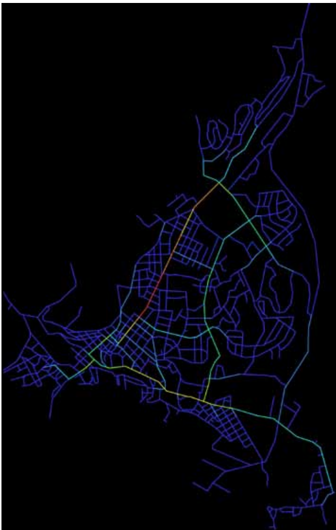
Figur 3.3a: Hovedruoter for dagens situasjon. Analysen viser forholdet mellom integrasjon og rutevalg, og stemmer godt overens med hovedvegstrukturen som identifiseres i kommunedeplan Larvik by (se figur 2.11).
