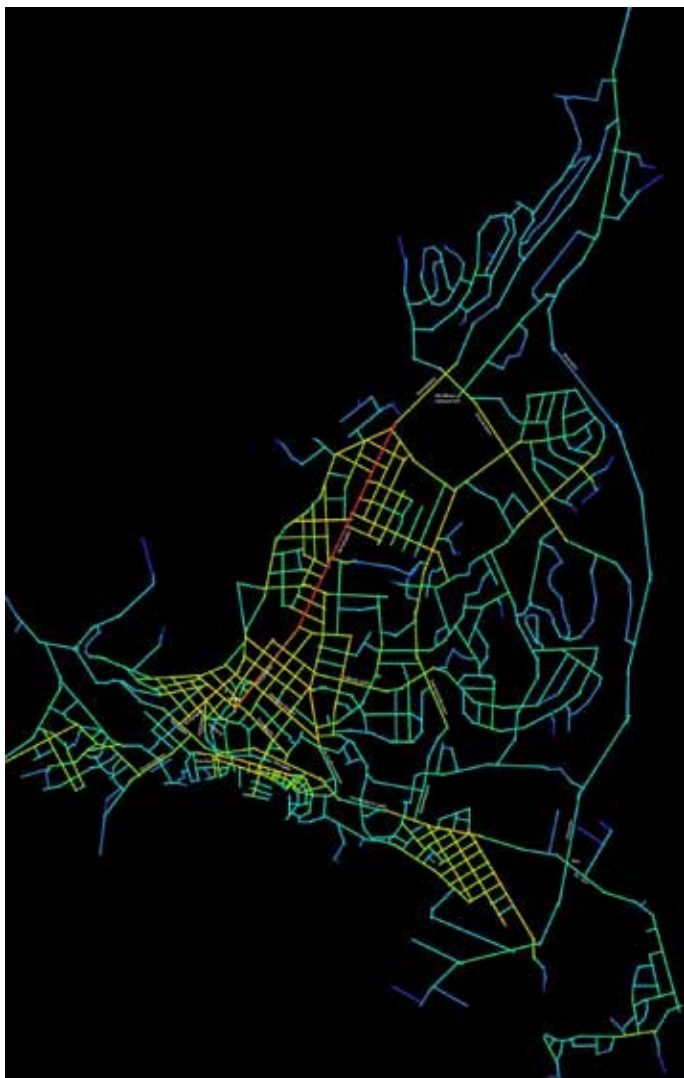
Figur 3.13a: Lokal integrasjon R3 for Connecting Larvik. Analysen viser høye integrasjonsverdier for Indre havn, men ikke like høye som for øvre del av sentrum. Området mellom øvre og nedre del av sentrum har lavere verdier, selv om de er over middels. Dette kommer tydelig fram av analysen med radius 3.
