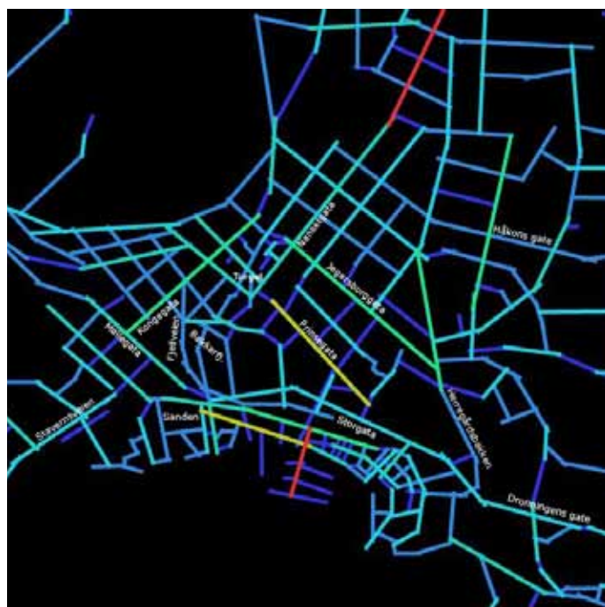
Figur 3.17: Utsnitt av kontrollverdi for Connecting Larvik. ”Blindveiene” i kaianlegget til Indre havn gir seg utslag i høye kontrollverdier for to av aksene.
