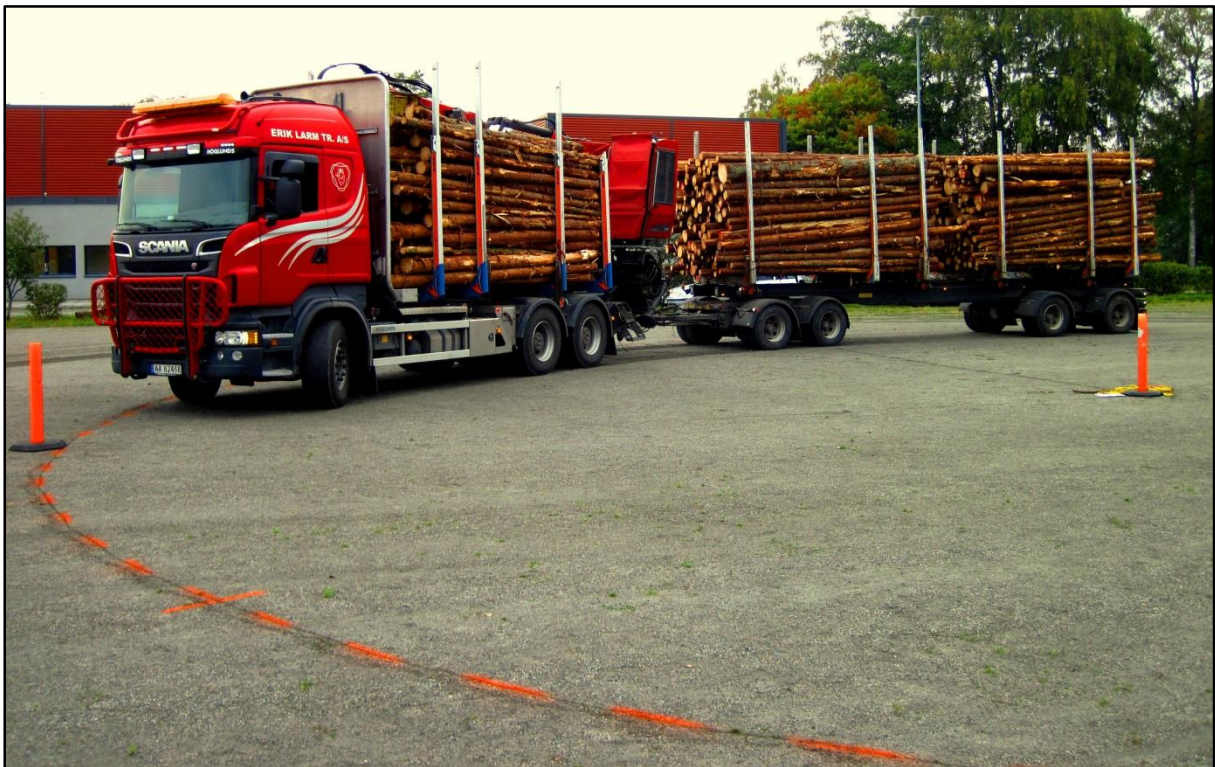
Figur 13: Spøringsforsøk med 22 meters vogntog. Vogntoget kjørte langs den oppmerkede linja som her har en radius på 12 meter. Vogntoget tilhører Erik Larm AS. Foto: Erik Gjerstadberget
