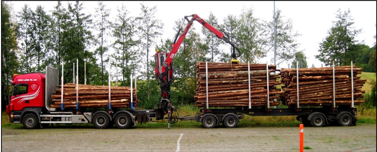
Figur 6: Et 22 meters vogntog som lesser ett lass med massevirke. Sjøføren har ikke problemer med å lesse da han har plass nok på tilhengeren da stokklengden er under 5 meter. Når sjåføren er ferdig med å lesse kan han trekke den bakre buntene fremover på tilhengeren og “stenge igjen” lysåpningen som blir mellom buntene og de bakerste stokkene kommer innenfor ramma på tilhengeren. Dette er for å unngå overheng da bilen skal kjøre på vei for 22 meter tillat total lengde. Foto: Erik Gjerstadberget
