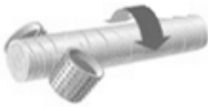
Figur 6 Prinsipp tegning av en vrider. Metallhjulene på figuren vinkler seg slik at de vrir tømmerstokken til ønsket posisjon. (Foto: http://www.se-saws.no/ )
