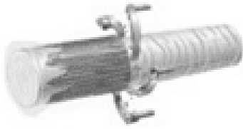
Figur 3 Prinsipptegning av en barkemaskin. Tømmerstokken passerer knivene som presses mot og roterer rundt stokken for å skrape av barken. Barken faller ned og føres til ett lager med hjelp av et transportbånd. (Foto: http://www.se-saws.no/ )
