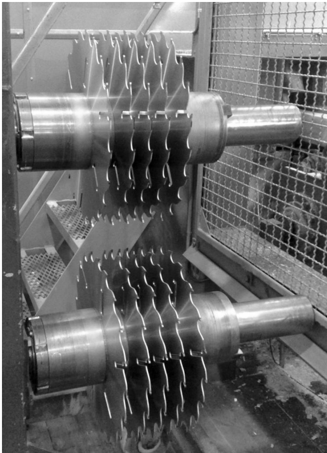
Figur 2 Bilde av over- og underliggende sagblad. Avstanden mellom bladene er det som utgjør postningen. (Foto: Brede Rogstadkjærnet)
