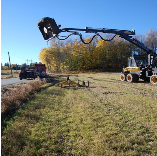
Figur 13. Ryddeaggregatet Slagkraft TW 150-80 monteres på jordet ved Asperudfeltet. Maskinell rydding krever relativt store arealer for montering av utstyr.
